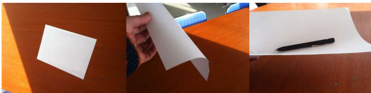
Fig. 2.13 Majtas: Fleta A4 në rrafsh ( \rho = 0 ); në mes: Fleta A4 e ngritur nga rrafshi; djathtas: sipërfaqja cilindrike e lirë dhe rritja e aftësisë mbajtëse ( \rho = \rho_0 ).
