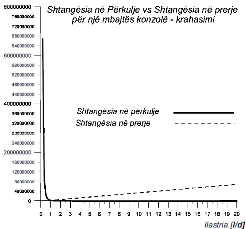
Fig. 4.14 Pjesëmarrja e shtangësisë në përkulje k_{përkulje} vs shtangësisë në prerje k_{prerje} për mbajtësin konzolë (ancak) nënshtruar veprimet të ngarkesës së përqendruar sipas Fig. 4.12.
