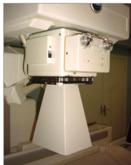
Figurë 1.8: Kolimatori i tufës se rrezeve x
