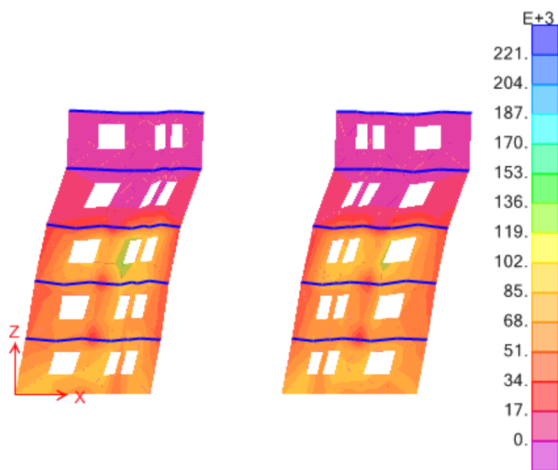
Figura 3-B.11 Sforcimi prerës në përforcim sipas X për rastin me CFRP për aksin A (kPa)
