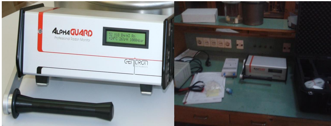
Figura 3.2.3.2 Metoda aktive e vazhduar Alpha GUARD për matje afatshkurtëra të radonit.
