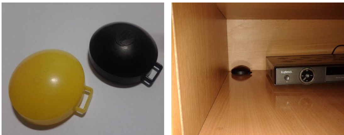
Figura 4.1.2.1 Detektorët NRPB dhe NRPB SSI (CR-39) të përdorur gjatë matjeve të përqendrimit të radonit.
