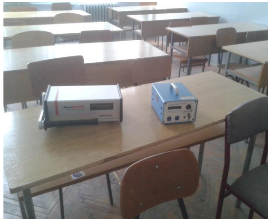
Figura 3.2.3.3 Metoda aktive e vazhduar CRM-510 për matje afatshkurtëra të përqendrimit të radonit.
