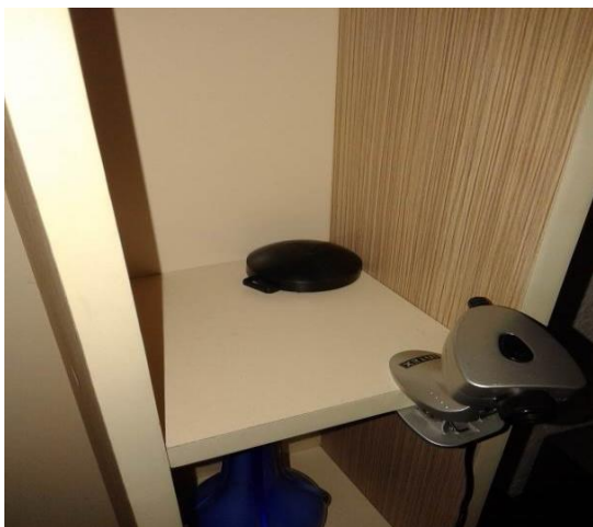
Figura 3.2.3.4 Detektorët e ngurtë të gjurmëve të përdorur gjatë matjeve pasive afatgjata.
