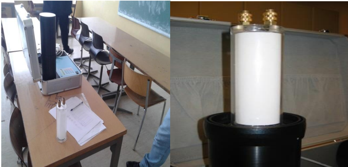
Figura 3.2.3.1 Metoda aktive afatshkurtër alfa shintiluese për matjen e radonit.
