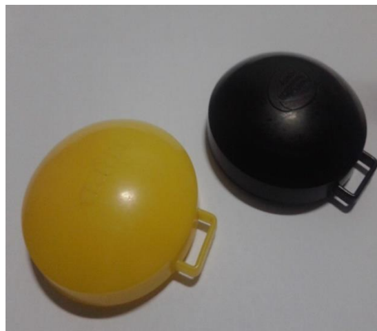
Figura 3.2.3.4 Detektorët e ngurtë të gjurmëve të përdorur gjatë matjeve pasive afatgjata.
