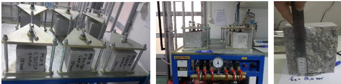
Foto 3.20 Përcaktimi i ujë-përshkueshmërisë
