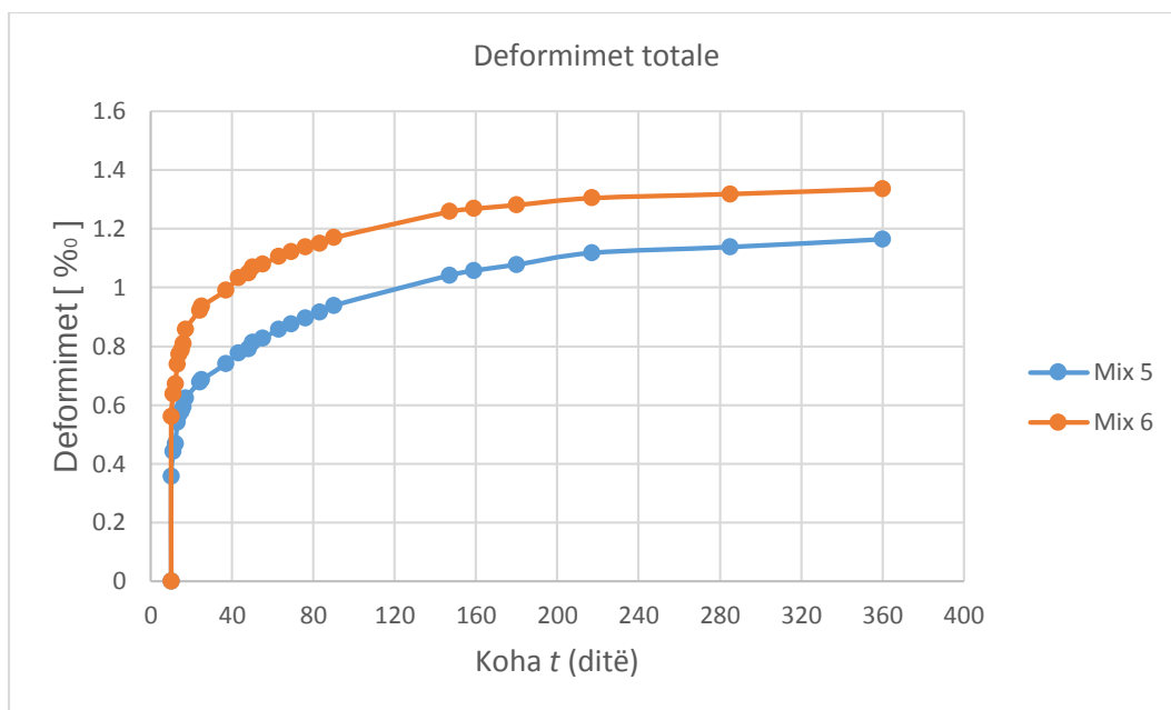
Figura 5.50 Deformimet totale Mix 5 – Mix 6
