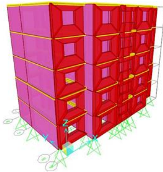
Figura 4.3 – Modeli 3-Dimensional i projektit fillesatr tip-77/11 ne Sap2000
