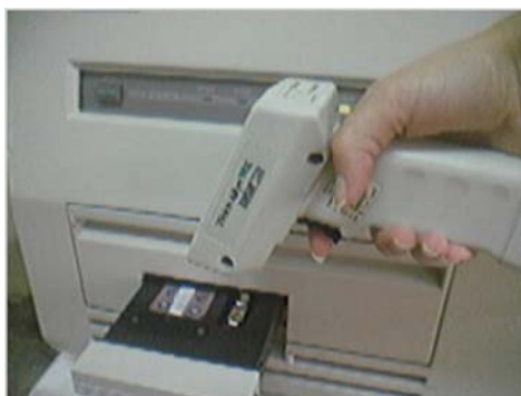
Figura 14. Futja e numrit të kartës TLD me barcode-scanner
