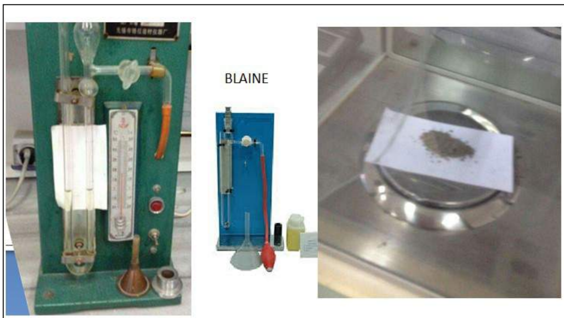
Figura 4.17: (a) Pajisja BLAINE për përcaktimin e sipërfaqes specifike të Trepelit.
