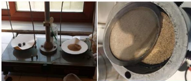
Figura 4.14: a,b: Peshore e kalibruar (a), materiali filtrues i vendosur brenda në press filtër (b).
