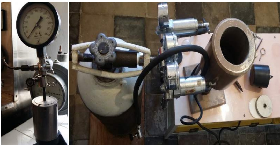
Figura 4.15: a,b: Press filtri standard D = 55 mm, H = 177 mm (a), (b) Baroid i pajisur me Press Filtër me rezistencë elektrike.
