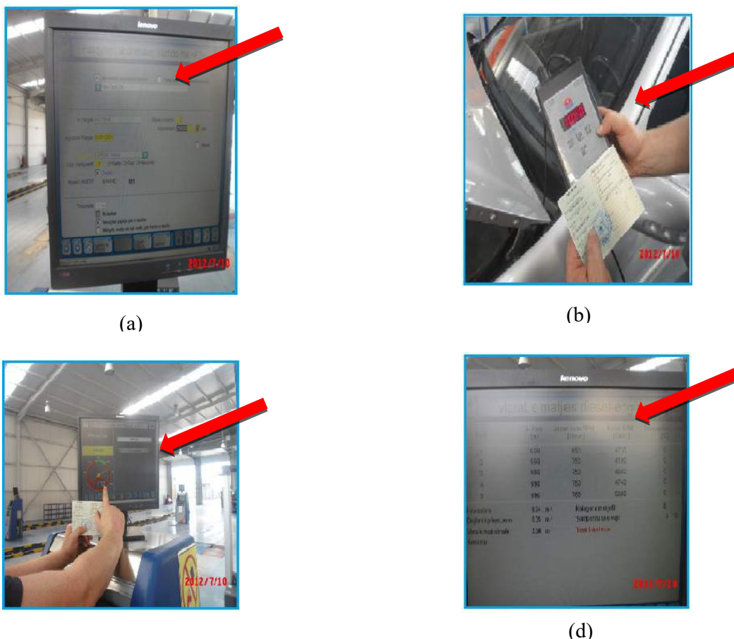
Figura 4.10: (a) zgjedhja dhe hedhja e të dhënave kryesore, (b) lidhja e MDO2 -LON me RPM, (c) matja e opacitetit me RPM, (d) fundi i testit me rezultatin Fail 9.9 m -1 kundrejt k_{lej}=2.5 \text{ m}^{-1} .
