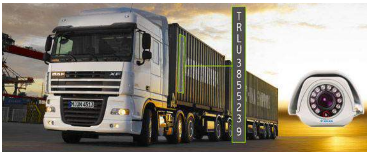
Figura 81: Telekamera për leximin e kodit KEMLER në konteinerë
