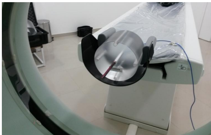
Fig. 5.11. Pozicionimi i dhomës jonizuese (PTW T30009) në qendër të fantomës PMMA
