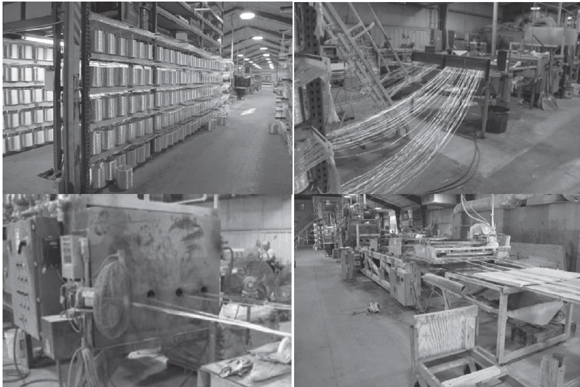
Fig. 1.14 Fazat e ndryshme të procesit të prodhimit të shufrave GFRP me pultruzion: (a) fibrat e mbështjella në bobina; (b) kalimi i tyre në banjën me rezinë; (c) shufrat GFRP të prodhuara; (d) prerja e shufrave në gjatësinë e kërkuar.
