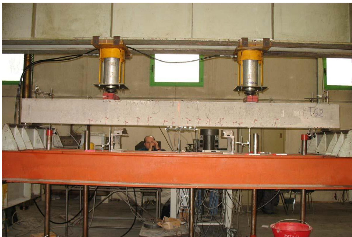
Fig. 6.20 Trau T2- Faza ndërmjetëse e ngarkimit, shfaqja dhe zhvillimi i plasaritjeve (30 kN)
