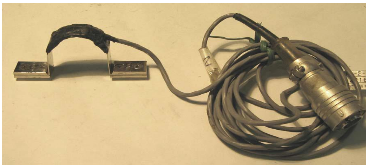
Fig. 6.4 Pamja e një matësi plasaritjesh “ \Omega ” së bashku me kallon që lidhet me aparatit
