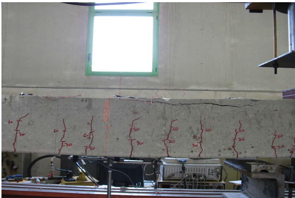
Fig. 6.24 Trau T2- detaj i shkatërrimit të traut në zonën e shtypur të betonit
