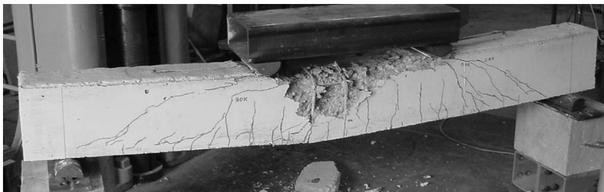
Fig. 2.7 Shkatërrimi i një trau të mbi-armuar me shufra FRP
