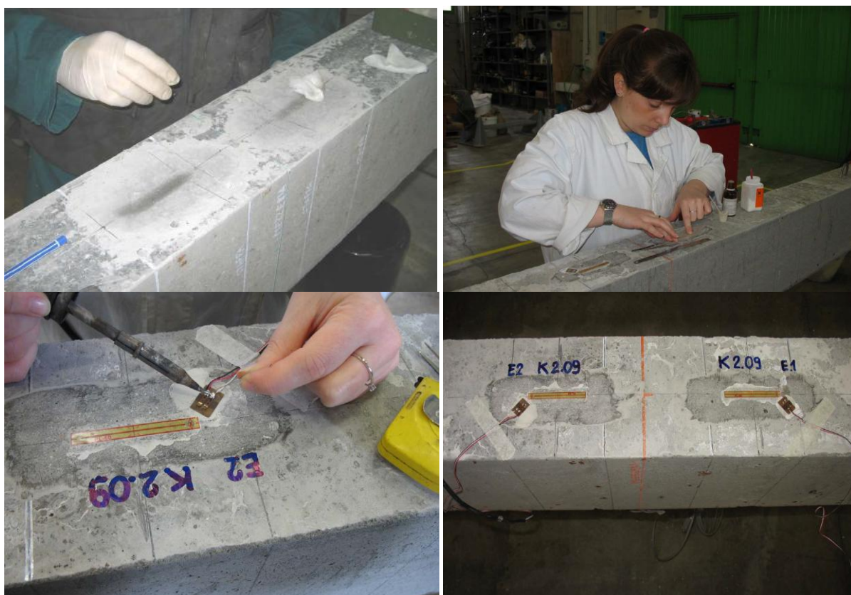
Fig. 6.10 Fazat e përgatitjes së traut për provën eksperimentale
