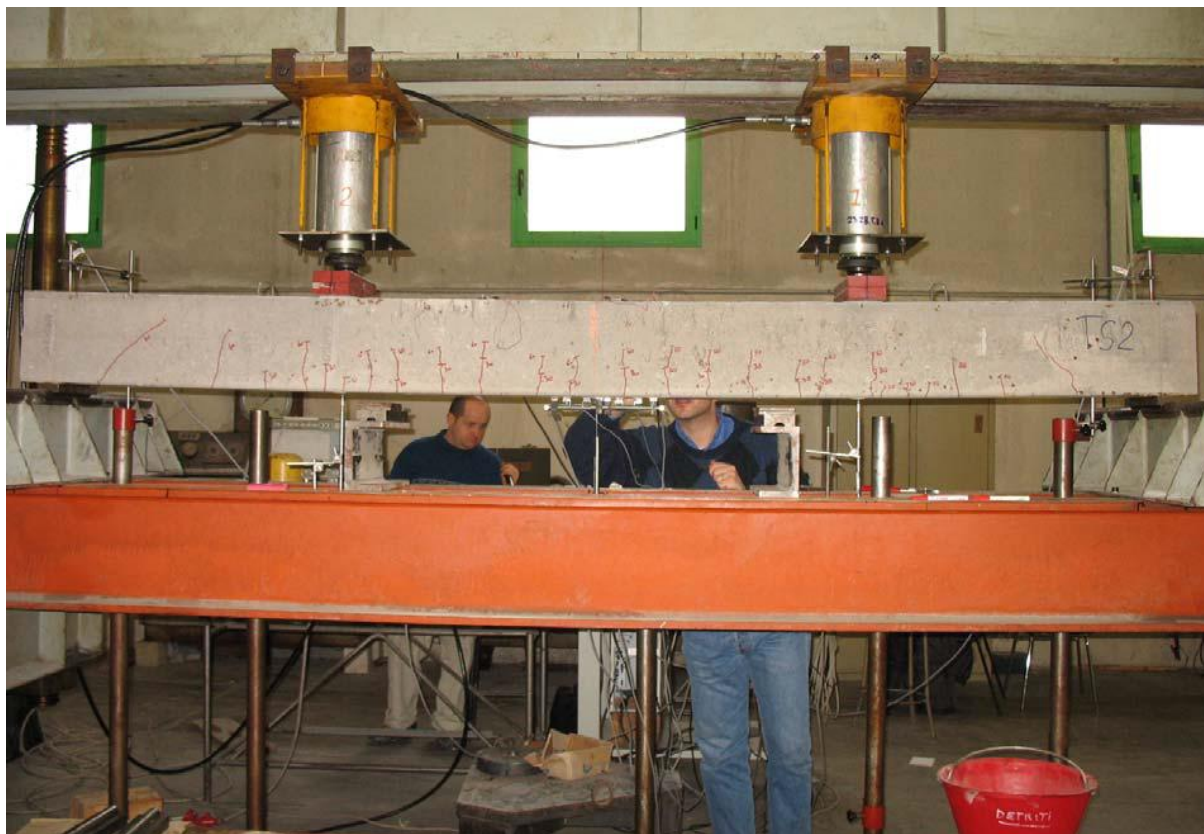
Fig. 6.21 Trau T2- Faza ndërmjetëse e ngarkimit, zmadhimi i plasaritjeve (60 kN)
