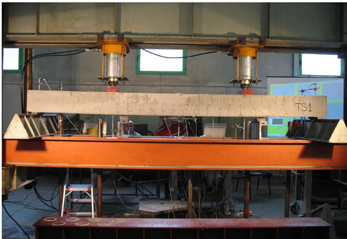
Fig. 6.15 Trau T1- Faza ndërmjetëse e ngarkimit, zmadhimi i plasaritjeve (60 kN)
