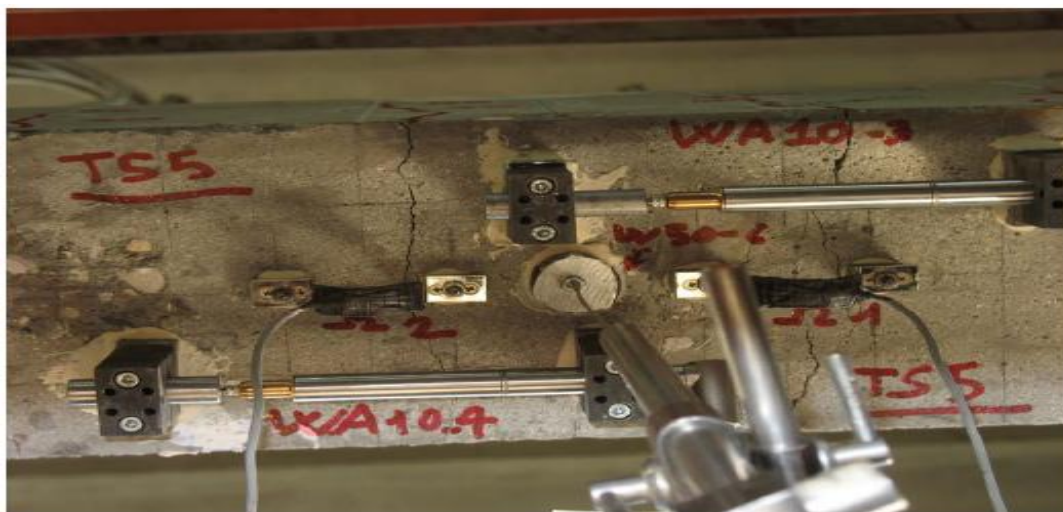
Fig. 6.5 Montimi në pjesën e poshtme të trarëve të matësve të plasaritjeve “ \Omega ” dhe të uljeve LVDT
