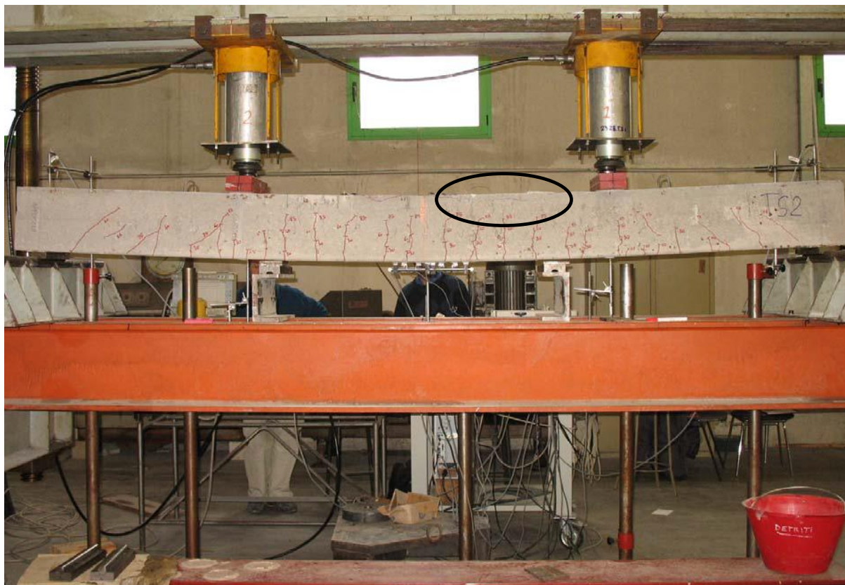
Fig. 6.23 Trau T2- Faza përfundimtare, shkatërrimi i traut në zonën e shtypur të betonit, zhvillimi i plotë i plasaritjeve ( \approx 90 kN)
