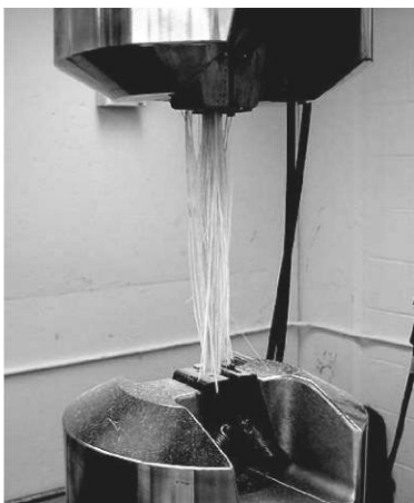
Fig. 1.17 Shkatërrimi i shufrave GFRP në tërheqje aksiale
