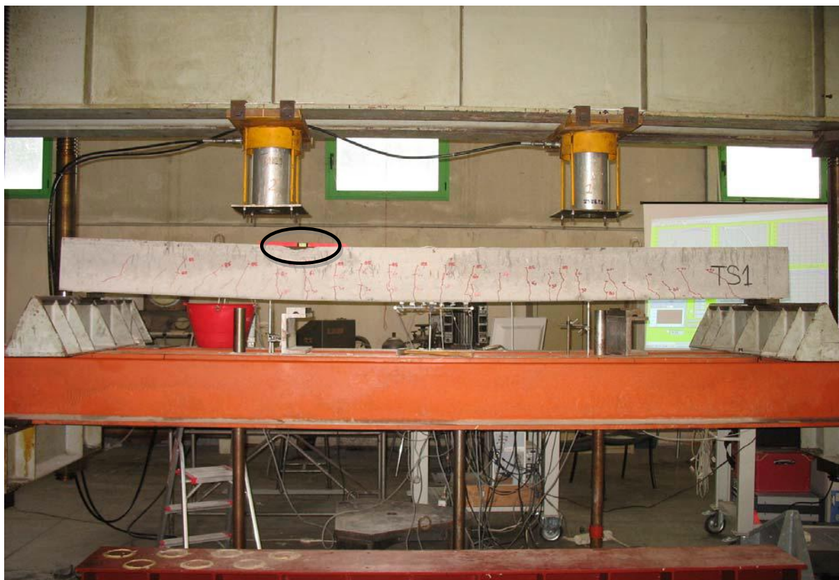
Fig. 6.17 Trau T1- Faza përfundimtare, shkatërrimi i traut në zonën e shtypur të betonit, zhvillimi i plotë i plasaritjeve ( \approx 90 kN)
