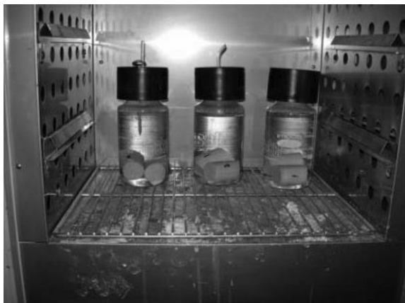
Fig. 1.20 Testimi për lagështi të shufrave FRP
