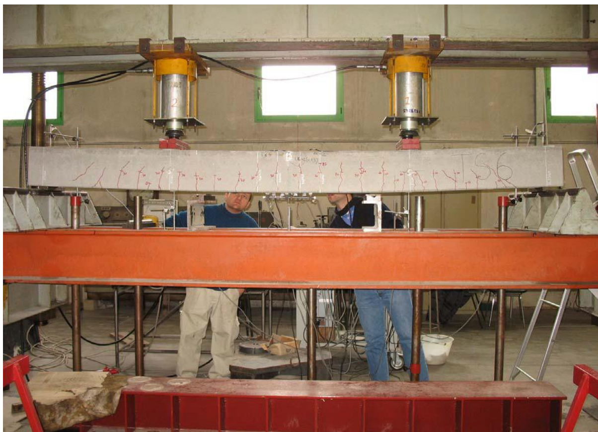
Fig. 6.28 Trau T4- Faza përfundimtare para këputjes së shufrave GFRP ( \approx 55 kN)
