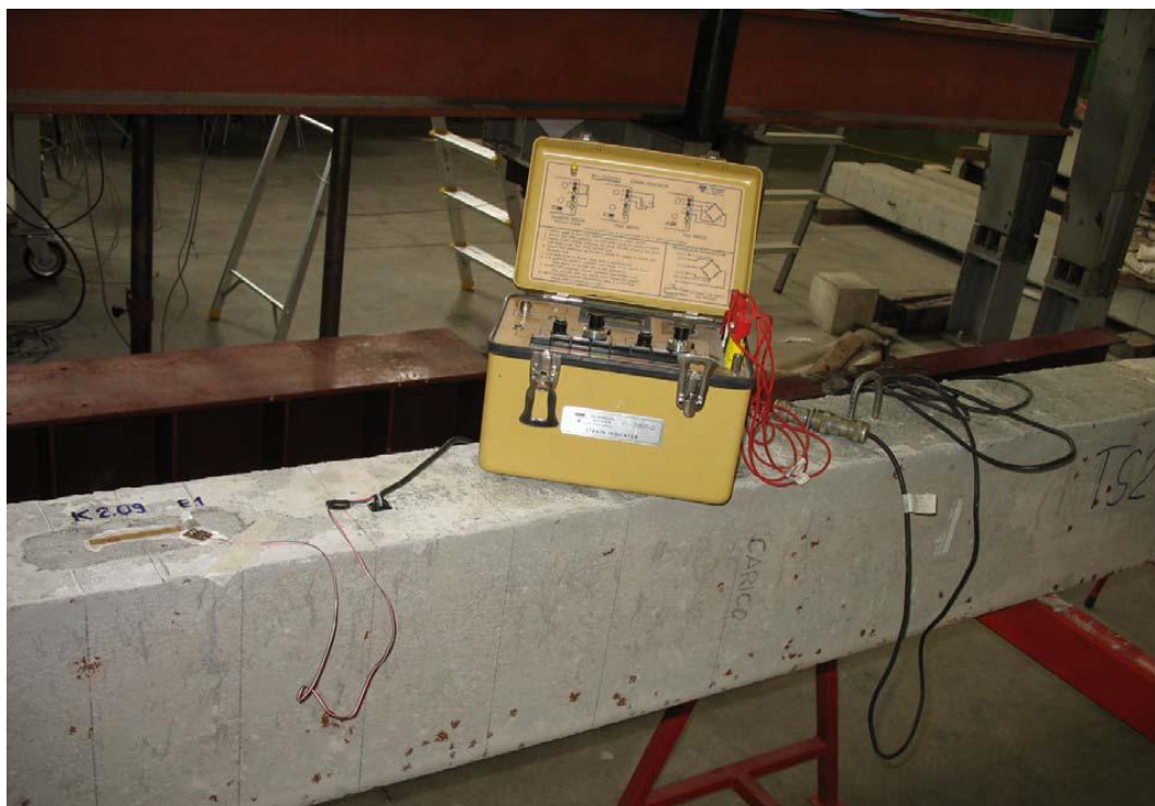
Fig. 6.9 Aparati portativ regjistruar i të dhënave P3500
