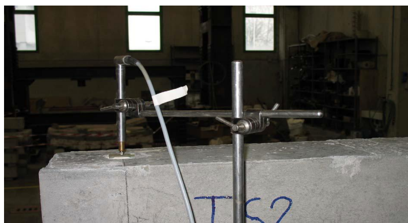
Fig. 6.7 Pozicionimi i matësit të uljeve LVDT
