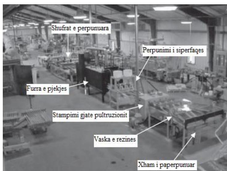
Fig. 1.13 Procesi i prodhimit të shufrave GFRP me pultruzion
