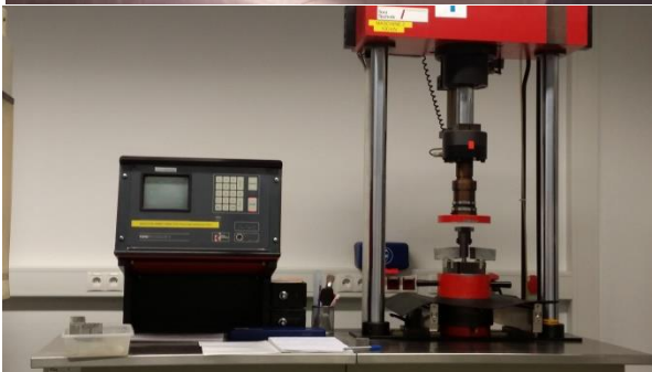
Figura 3.8: Lart majtas tregohet si transportohen kampionët përpara se të testohen për rezistencën ndaj ngjeshjes dhe përkuljes te treguar nga makineria lart djathas dhe poshtë.
