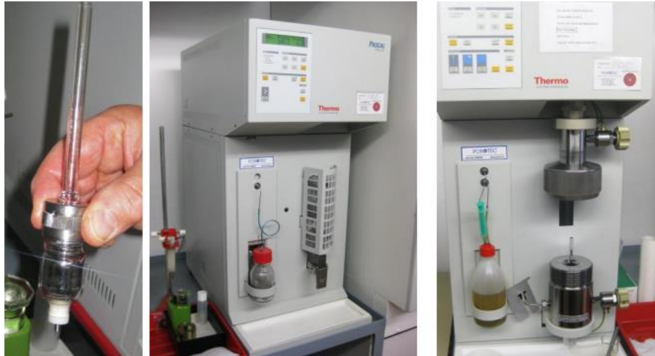
Figura 3.3: Mbajtësja speciale ku vendoset kampioni dhe gryka e gjatë e mbushur me mërkur, b) Paisja MIP e presionit të ulët, c) MIP e presionit të lartë.
