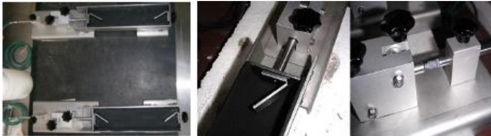
Figura 3.5: Tregohen kanalet mbajtës të veshur me shtresë polimerike si dhe sensori i cili është i lidhur me kompjuterin nga ku marrim të dhënat për periudhën 10 sekonda.
