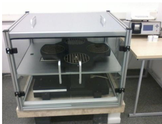
Figura 2.6. Komparatori i masës AX1005, specifikimet teknike dhe grafiku
