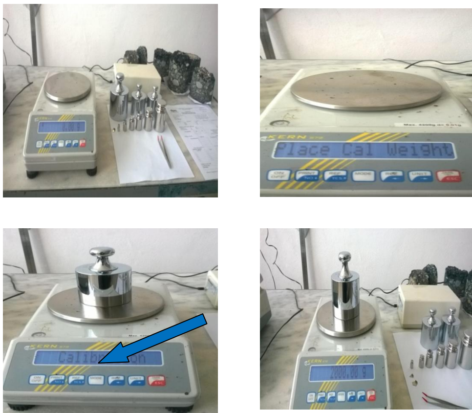
Figura 7.5. Proçesit i rregullimit të peshores sipas manualit të saj të përdorimit
