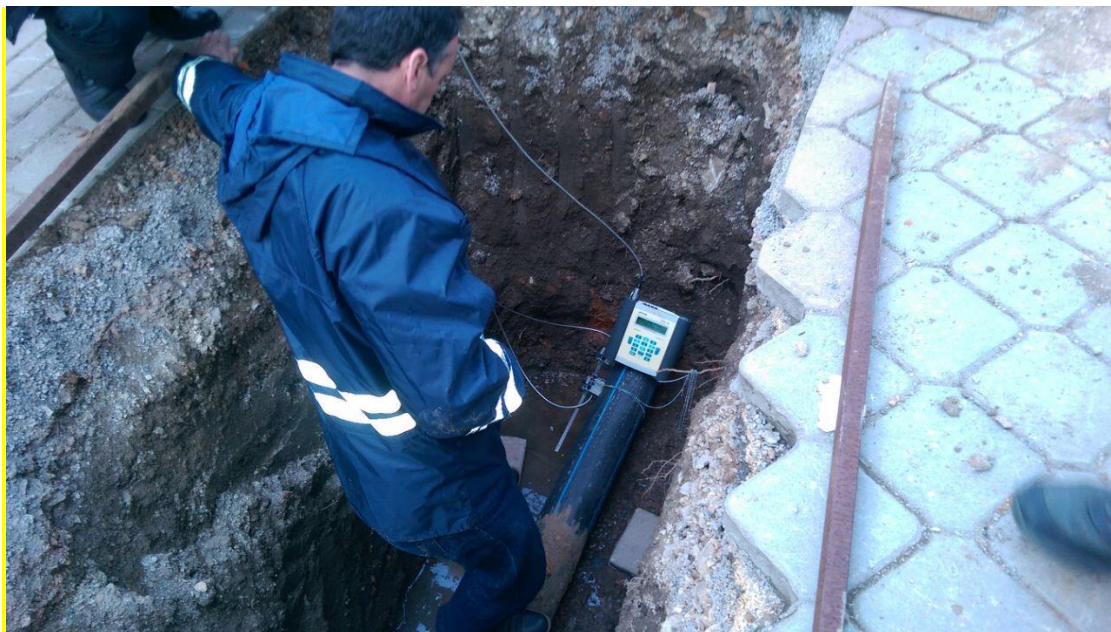
Figura 3.2 Matja e rrjedhjes në tubin primar PE-100;PN-10bara,OD-110mm
