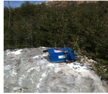
Figura 7-32 Instalimi i njësive të regjistrimit në terren, montim me platforma metalike
