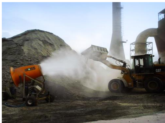
Figura 3-5 Foto, Spërkatja me ujë e ngarkimit të mineralit dhe impiantit të thyerrje fraksionimit.
