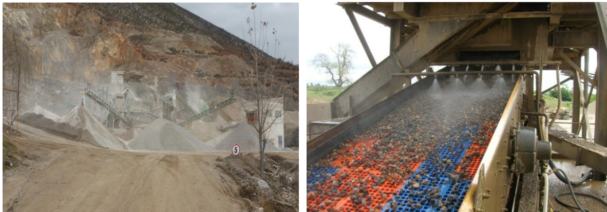
Figura 7-52 Foto, Impianti i thyerrje fraksionimit dhe sitat vibruese me material poliretani
