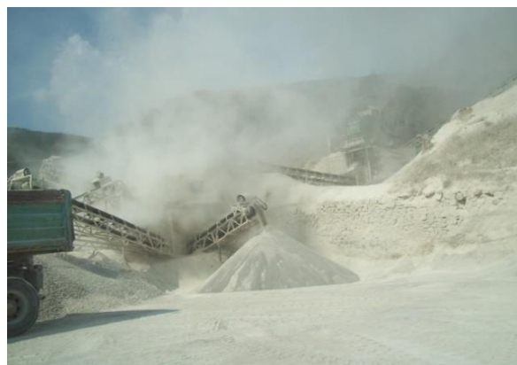
Figura 3-4 Foto, Përhapja e pluhurit gjatë punëve të shpim-plasjes Fushë Krujë (majtas) dhe në një impiant thyerje-fraksionimi (djathtas, Foto, Zona e rajonit të Krujës)
