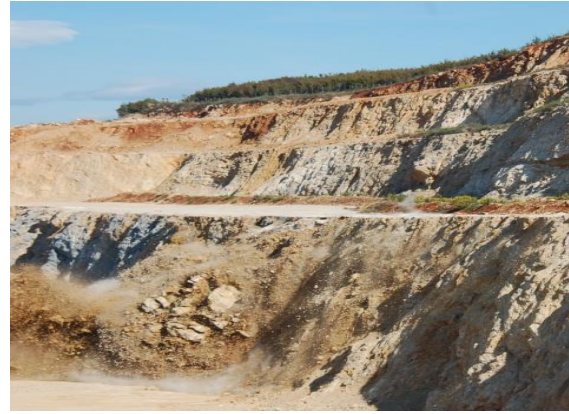
Figura 7-31 Procesi i shpërthimit në karriera dhe përfitimi i gurit gëlqeror të copëtuar [Burimi: Foto nga autori, karriera e Borizanës dhe Fushë Krujë]
