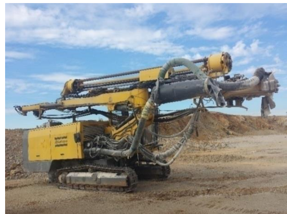
Figura 6-3 Foto të sondës Atlas Copco Roc L6, që përdoret për shpimin e puseve.
