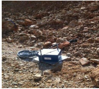
Figura 7-32 Instalimi i njësive të regjistrimit në terren, montim me platforma metalike
