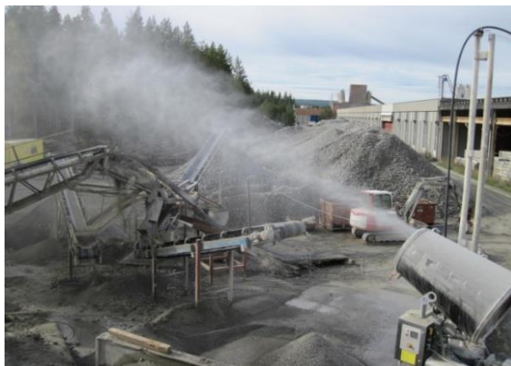
Figura 3-7 Spërkatja e rrugëve të transportit dhe impiantit të thyerrje fraksionimit me ujë.
