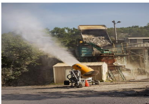
Figura 3-6 Foto nga Spërkatja me ujë e shkarkimit të mineralit në bunker dhe nga transportieri në stoqet. Shëmbull nga minierat në US – Linwood
