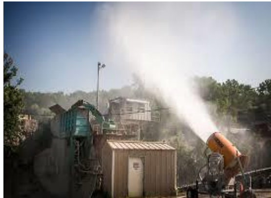
Figura 3-5 Foto, Spërkatja me ujë e ngarkimit të mineralit dhe impiantit të thyerrje fraksionimit.
