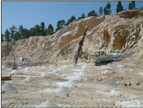
Figura 7-24 Sonda e shpimit Tip “Atlas Copco” dhe pajisja e kapjes së pluhurit Fushë Krujë.
