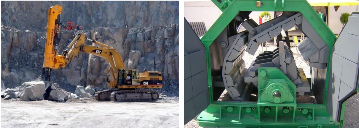
Figura 7-51 Foto, Çekiçi hidraulik i vendosur në krahun e eskavatorit për ricoptim dhe thyerrsi me nofulla.
