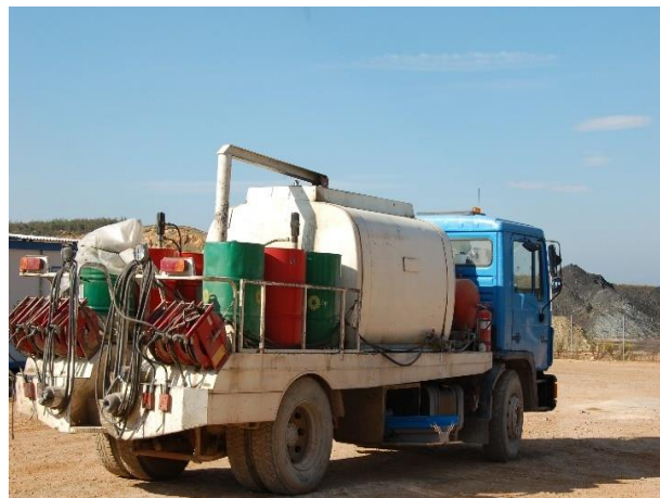
Figura 6-20 Autoçisterna e karburantit me pajisjet përkatëse për grsatimin e mjeteve të punës.
