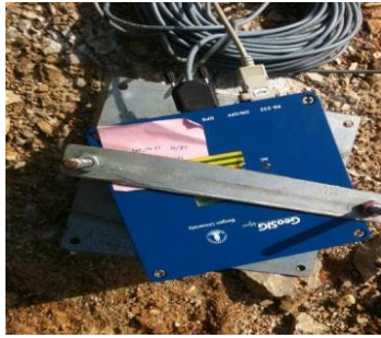
Figura 7-32 Instalimi i njësive të regjistrimit në terren, montim me platforma metalike
