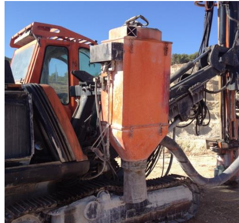
Figura 7-24 Sonda e shpimit Tip “Atlas Copco” dhe pajisja e kapjes së pluhurit Fushë Krujë.
