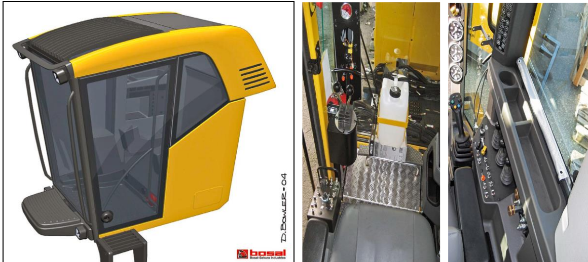
Figura 7-19 Pamje e kabinës dhe kuadrit të drejtimit së pajisjes të shpimit
