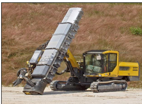
Figura 7-10 Pamja e pajisjes shpuese e tipit Atlas Copco Silenced Smart Rig dhe shfaqjeve të zhurmës tregon ndryshimin me dhe pa paketën e heshtjes (silencioze)
