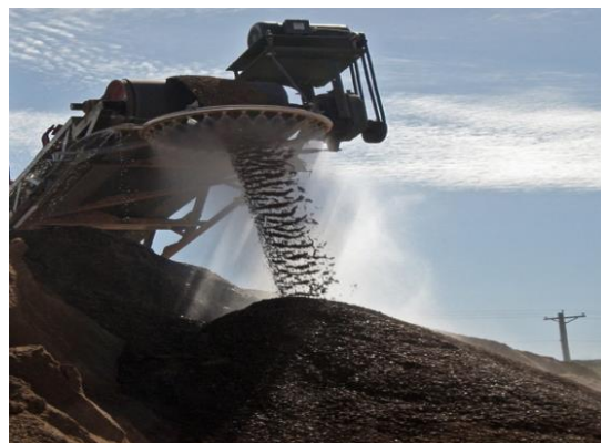
Figura 3-6 Foto nga Spërkatja me ujë e shkarkimit të mineralit në bunker dhe nga transportieri në stoqet. Shëmbull nga minierat në US – Linwood
