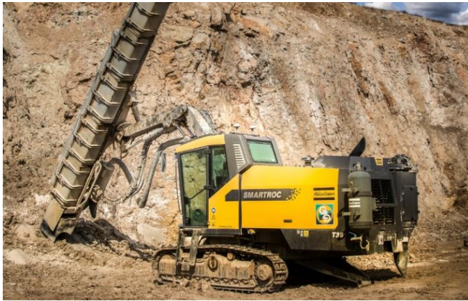
Figura 7-6 Foto e Platforma e shpimit të puseve tip "Smart ROC"
