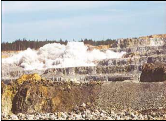
Figura 7-31 Procesi i shpërthimit në karriera dhe përfitimi i gurit gëlqeror të copëtuar [Burimi: Foto nga autori, karriera e Borizanës dhe Fushë Krujë]
