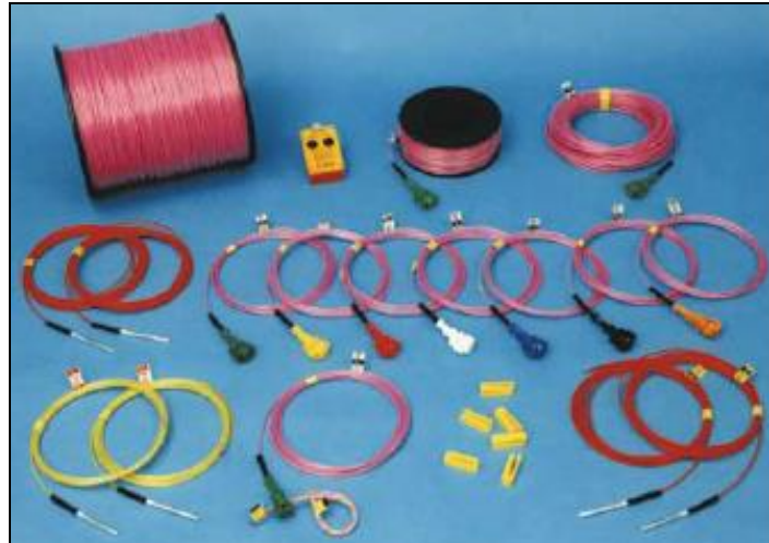
Figura 6-8 Elementët përbërës të sistemit NONEL
