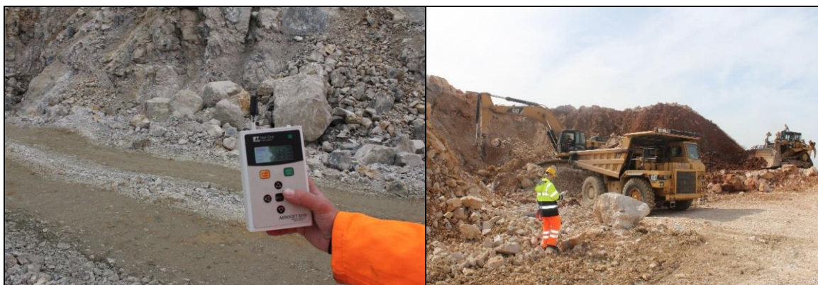
Figura 7-22 Aparati AEROCET 531S dhe matjet e realizuara në frontin e shfrytëzimit [Burimi: Foto nga autori, Monitorimi i grimcave të ngurta në karrierën e Fushë Krujë]
