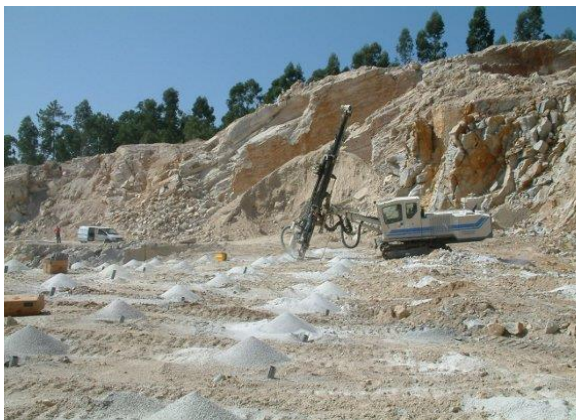
Figura 6-3 Foto të sondës Atlas Copco Roc L6, që përdoret për shpimin e puseve.
