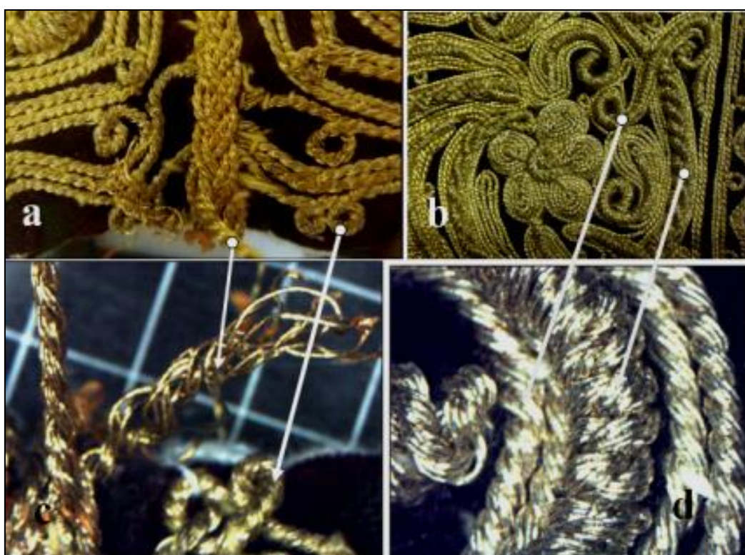
Figura 3.5.2.2. a, b, c, d. Analizimi i fijeve metalike në formë kordoni dhe gërsheti; Fotomikrografi e fijeve metalike në jelekët; Përdredhje gjashtë dhe tetë fijesh metalike; aplikim qëndisjeje kordoni, zinxhiri dhe gërsheti me bërthamë fijesh mëndafshi në brendësi; Përdredhje “S” e fijeve metalike.
