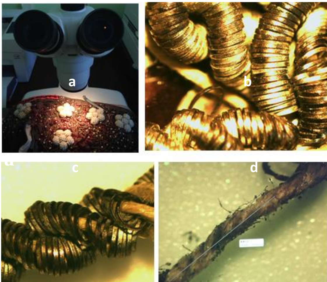
Figura 3.5.2.1. (a, b, c, d). Analizimi i strukturës morfologjike me anë të Steriomikroskopit optik; Fotomikrografi e telave në qëndisjen e jelekut të Krujës; teli në formë rrethore i përdredhur në formë spirale (fig.3.5.2.1.a, b, c); Fije treshe mëndafshi; përdredhje “S” e fijeve të mëndafshit 6 përdredhje/3 mm (fig.3.5.2.1. d).
