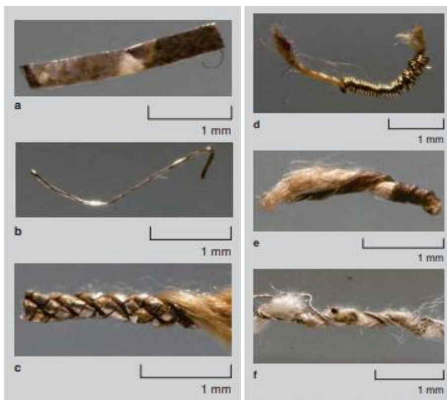
Fig. 3.5.1. Llojet e fijeve metalike: a) shiritë metalikë, b) tela, c) Shirit metalik i përdredhur rreth fijos mëndafshi; d) tela ari ose argjendi në formë rrethore të pozicionuara rreth një bërthame fibrash ose fijos tekstile, e) shirit organik i praruar, f) kombinim fijos metalike rreth tufës së fibrave apo fijos tekstile.
