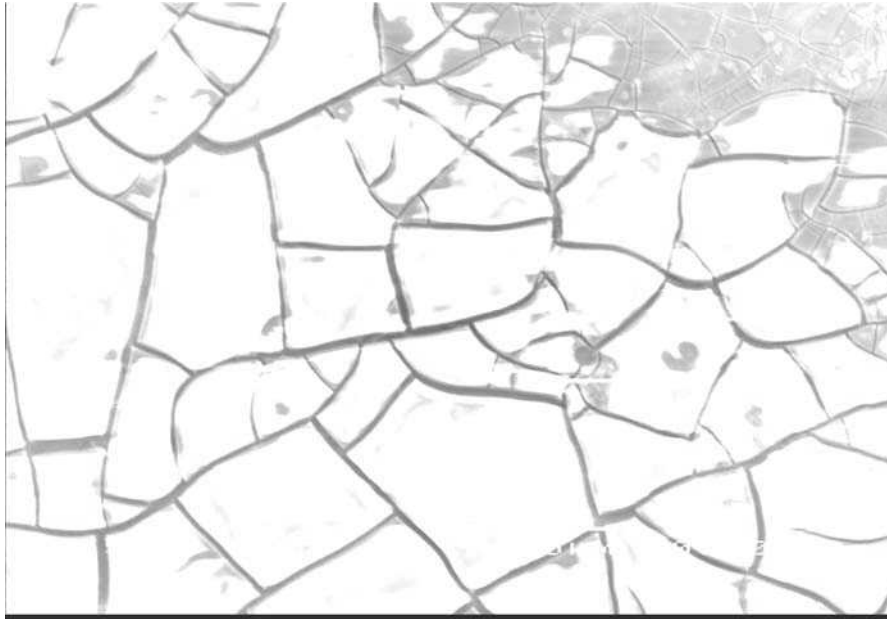
Figura 3.20 Fotografi mikroskopike me SEM e lidhjes AA 3004, në gjendje të papresuar.
