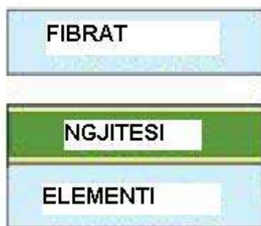
Figura 1.23 Shkatërrimi për shkak të dështimit të ngjitjes së dy materialeve
