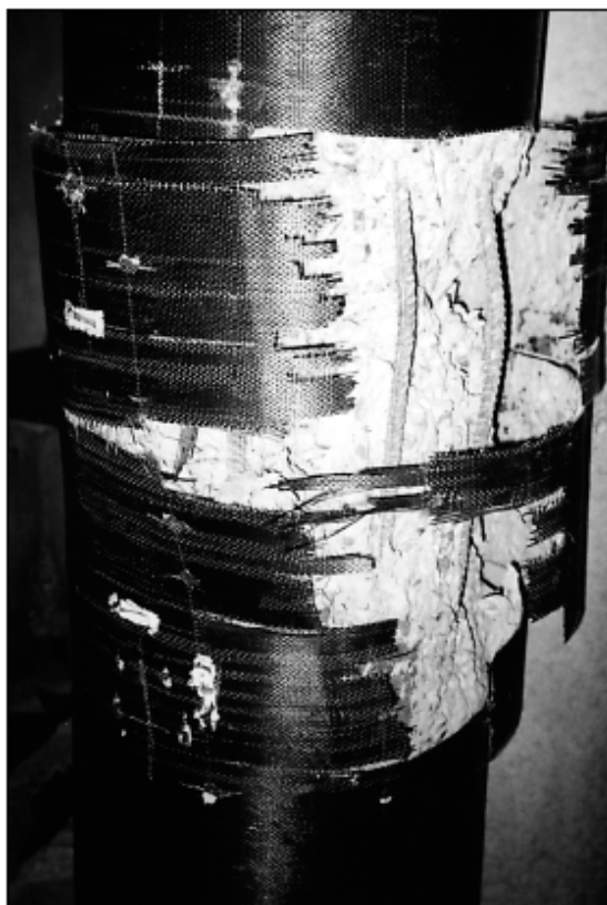
Figura 3.36 Rast i shkatërrimit të kolonës dhe përforcimit me FRP
