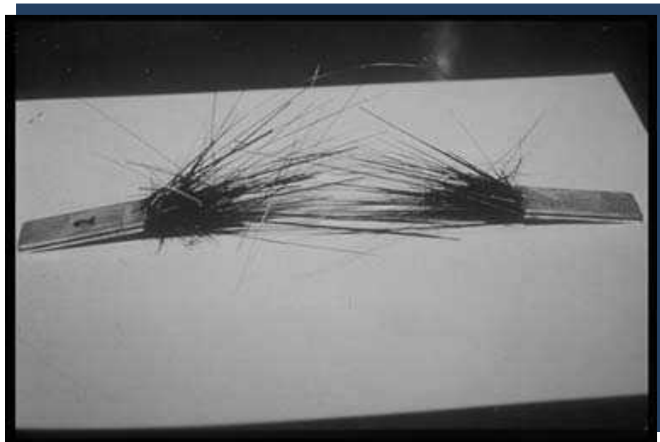
Figura 1.1 Fibrat përbërëse të FRP
