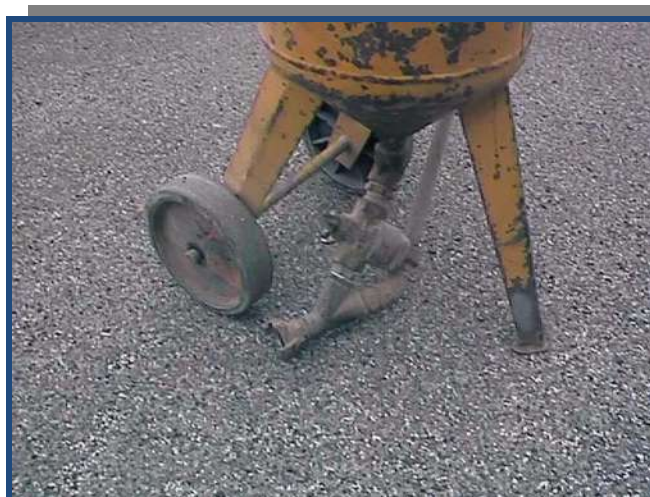
Figura 2.20 Pompa e rërës
