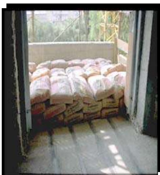
Figura 2.9 Prova me ngarkesë e soletës konsol të përforcuar me FRP
