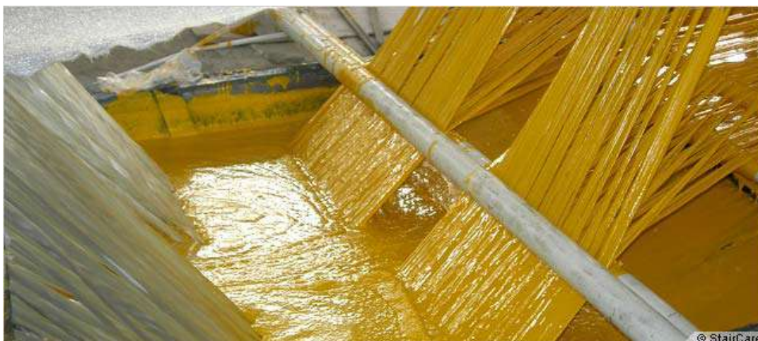
Figura 2.2 Zhytja e fibrave në vaskën me rezinë
