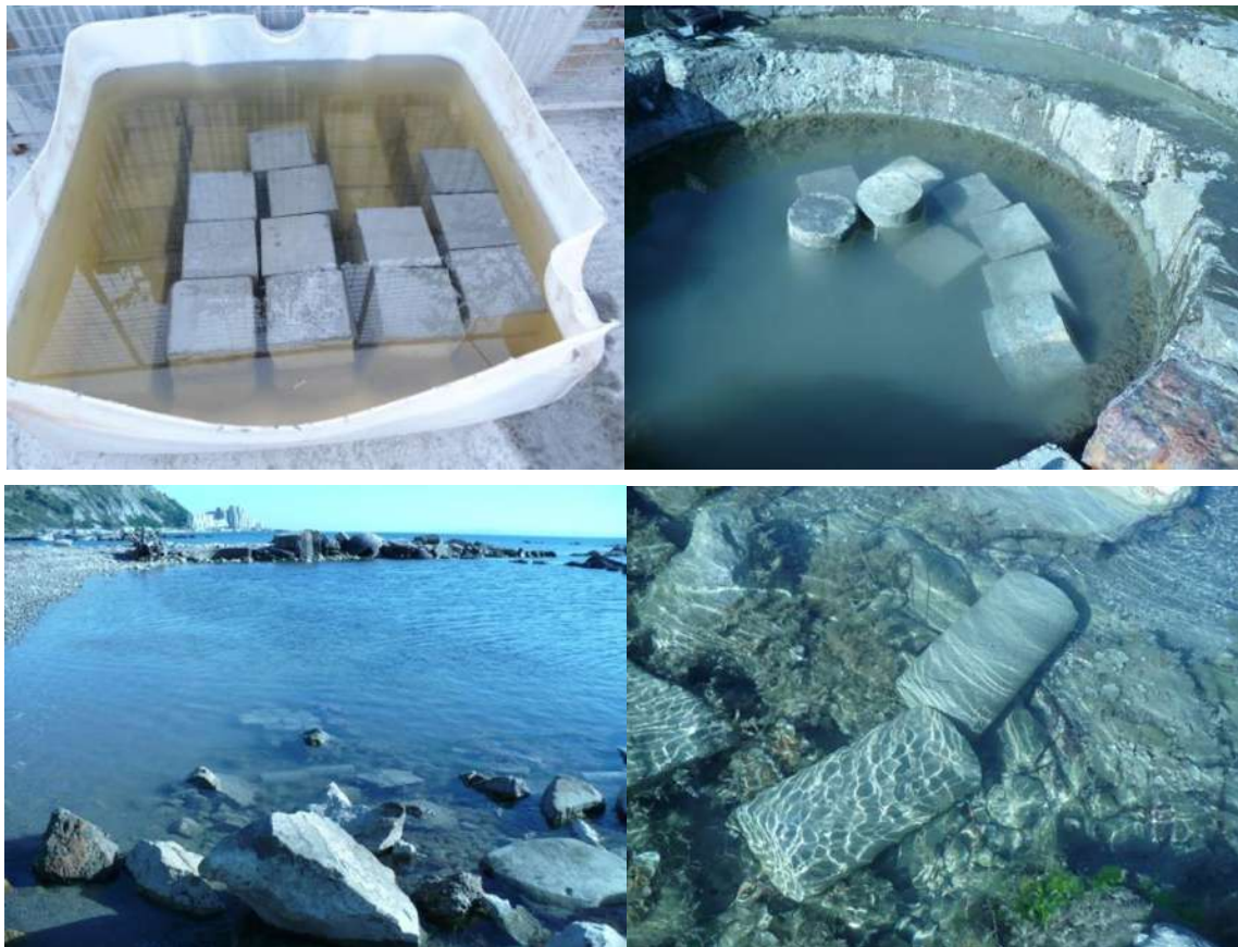
Figura 3.4.9 - 3.4.12: Trajtimi i kubikëve të betonit
