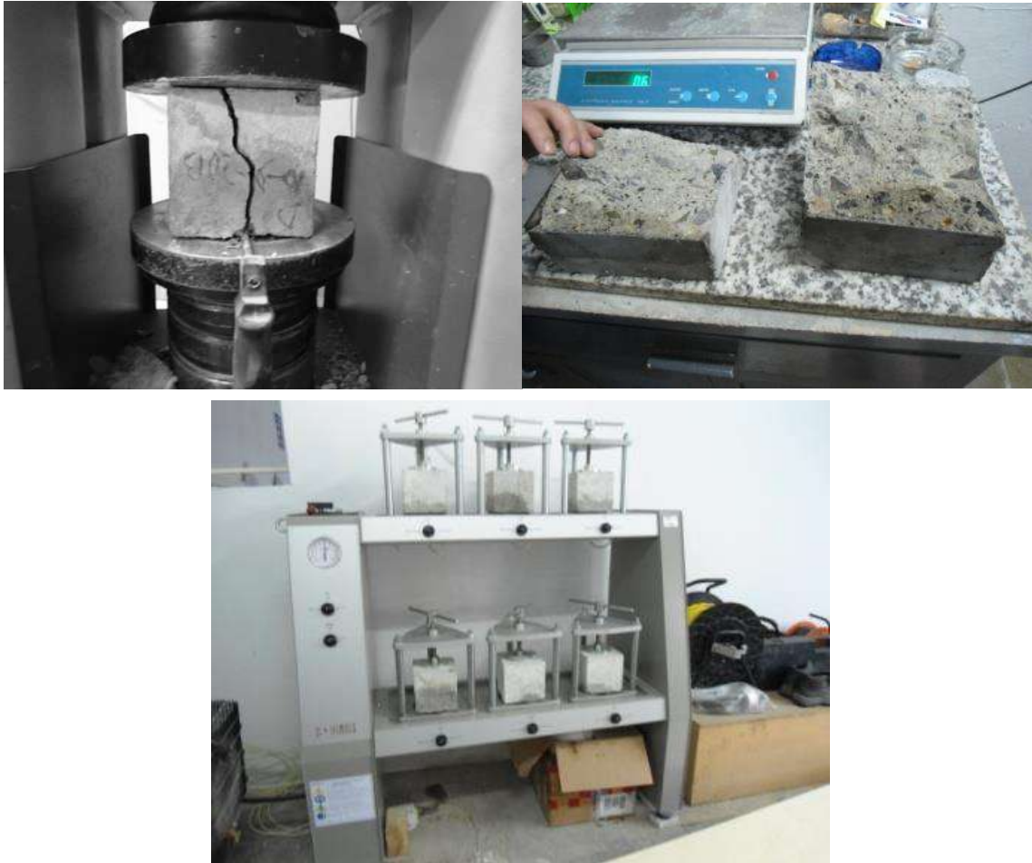
Figura 3.5.9.1 – 3.5.9.3: Procedura e testimit të përshkueshmërisë së ujit.
