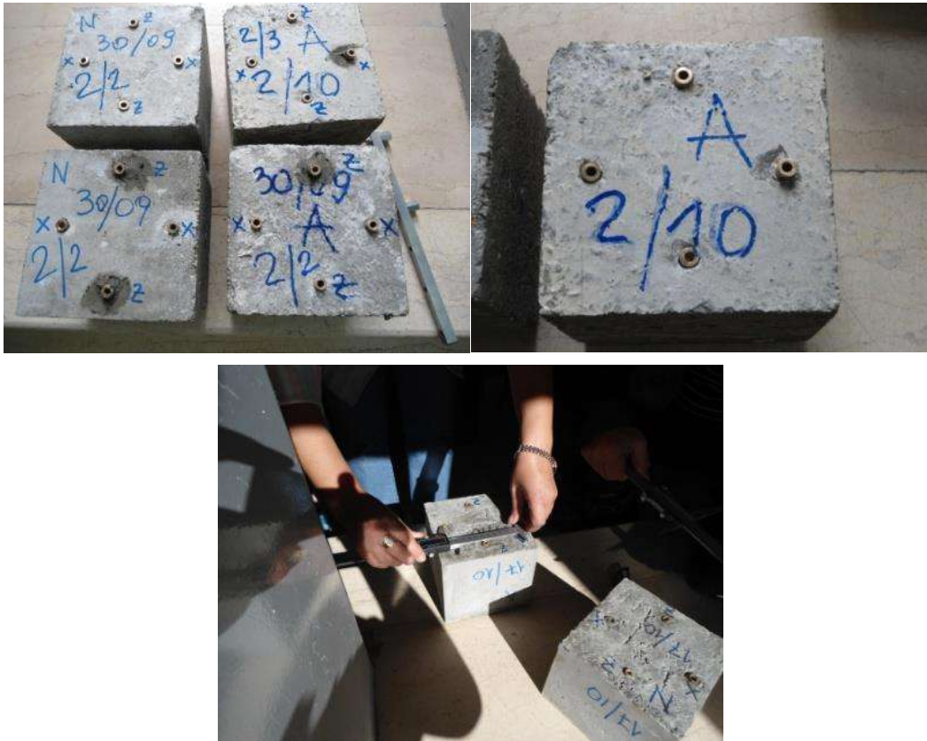
Figura 3.5.8.2 – 3.5.8.4: Procedura e testimit të përshkueshmërisë së ujit.
