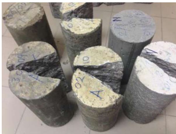
Figura 3.5.7.1: Testimet e kubeve për rezistencën në tërheqje
