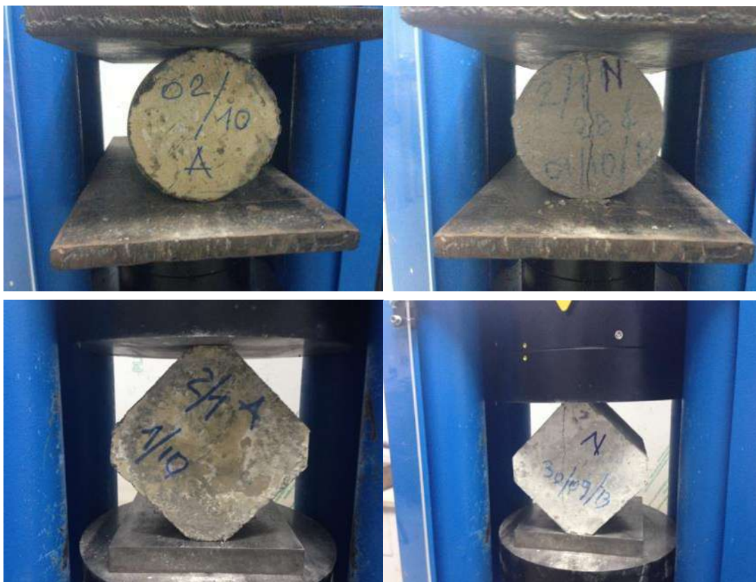
Figura 3.5.7.2 - 3.5.7.5: Testimet e kubeve për rezistencën në tërheqje
