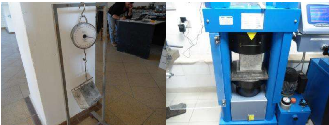
Figura 3.5.6.1, 3.5.6.2: Testimet e kubeve për rezistencën në shtypje
