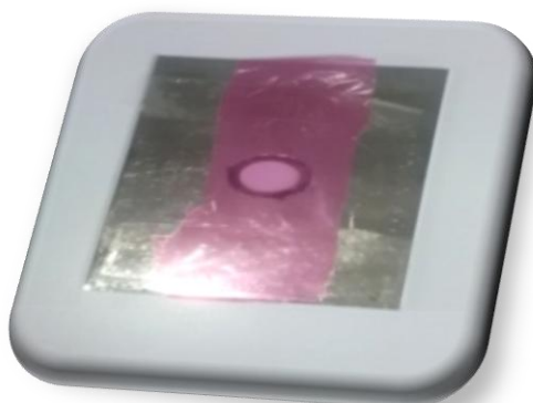
Figura.6.5. Mostra e LDPE së ricikluar e përgatitur për tu futur në Spektrofotometer.
