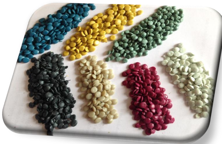
Figura.6.10. Granulat e LDPE së ricikluar (EVERETST I.E.), të përdorura për studim
