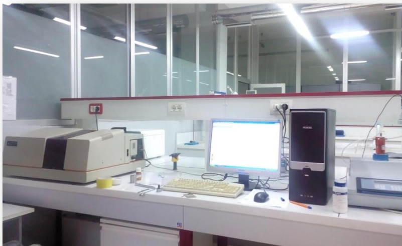
Figura.6.4. Aparati për analizën e spektrave Infra të Kuq (IR)
