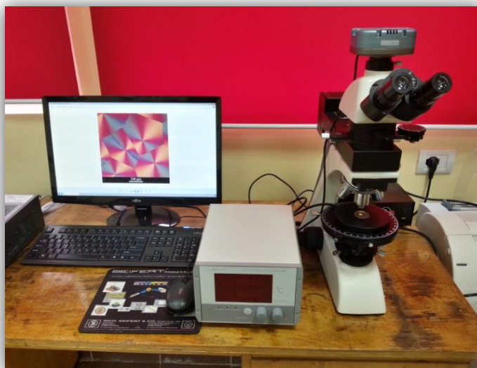
Figura.6.3. Mikroskopi me dritë të polarizuar me transmetim e me reflektim dhe me tryezë ngrohëse
