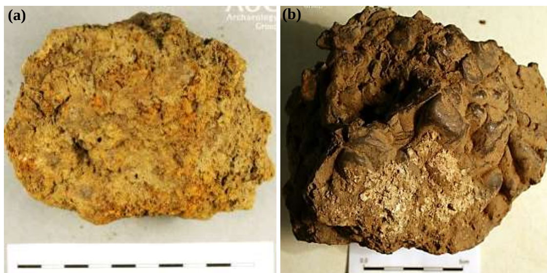
Figura 18. Shembuj skoriesh të gjetura ne Beechwood, Skoci; a) nga procesi i përpunimit të blumerit në farkë (smelting slag), b) nga procesi i shkrirjes së mineralit në furra (smelting slag).
