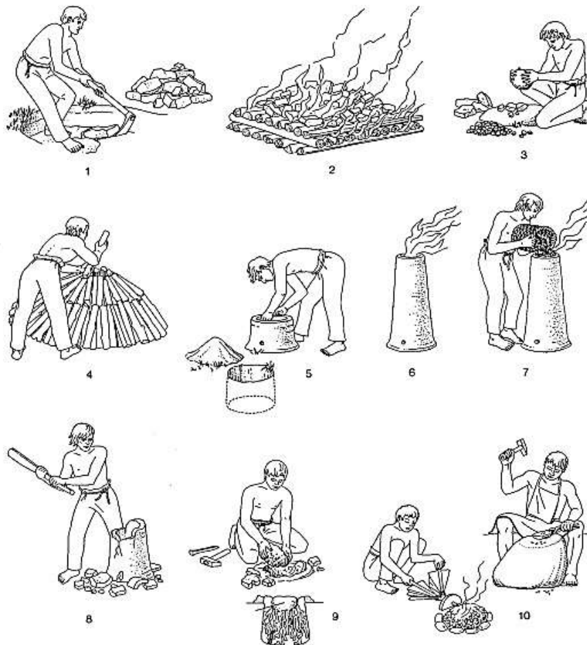
Figura 11. Fazat e prodhimit gjatë përpunimit të mineraleve të hekuri. 1. nxjerrja e mineraleve të hekuri, 2. pjekja e mineralit, 3. para përgatitja e mineralit, 4. prodhimi i lëndës djegëse, 5. ndërtimi i një furre cilindrike (shaft furnace), 6. ndezja e furrës, 7. shkrirja e mineralit duke furnizuar me lëndë djegëse shtesë dhe mineral, 8 dhe 9. heqja e blumerit nga furra, 10. farkëtimi primar.
