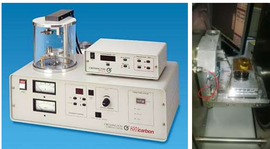
Figura 32. a) procesi i evapurimit në pajisjen 208C High Vacuum Turbo Carbon Coater, b) vendosja e kampionëve në dhomën e SEM-it.
