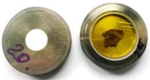
Figura 27. Pamje gjatë montimit të kampioneve pluhur dhe copë metalike për tu analizuar me XRD.
