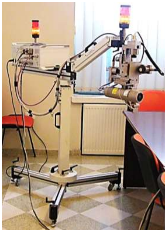
Figura 30. Portabëli \mu – XRF i përdorur për analizimin e objekteve të hekurit.
