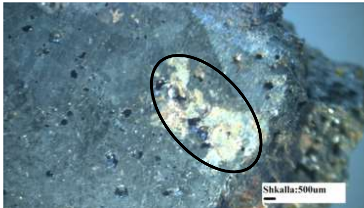
Figura 40. Pamje e marrë me stereomikroskop e një sipërfaqe të poleruar të skorjes Mërq 1. E qarkuar me elips është kokrriza me shkëlqim metalik e hekurit.
