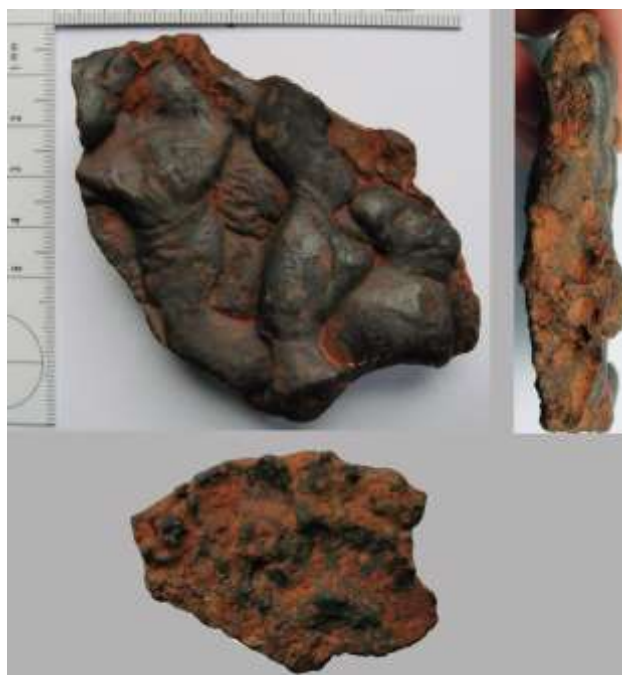
Figura 19. Skorie e zbuluar në 2011 në Brislington, Bristol, skorie e përftuar nga rrjedhja jashtë furrës nëpërmjet një kanali (tapping slag). Kjo skorie është e lëmuar nga njëra anë e saj.
