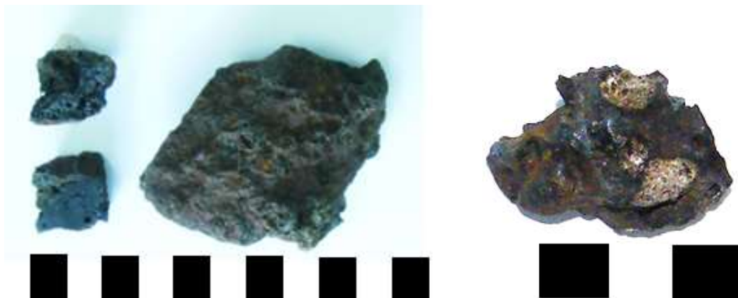
Figura 38. Pamja e jashtme; lart skorja Mërqi 1, poshtë majtas skorja Mërqi 1 së bashku me copat e ndara prej saj, të përgatitura për tu vëzhguar me mikroskop optik dhe poshtë djathtas skorja Mërqi 2. Çdo katror në shkallë = 1 cm.
