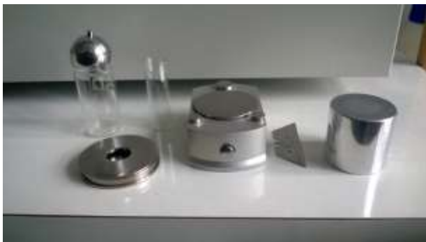
Figura 27. Pamje gjatë montimit të kampioneve pluhur dhe copë metalike për tu analizuar me XRD.
