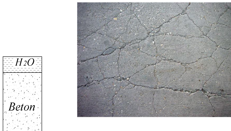
Fig.3.1.1. Skema e ndarjes së ujit nga betoni në tkurrjen plastike, plasaritjet sipërfaqësore nga ndikimi i tkurrjes plastike.
