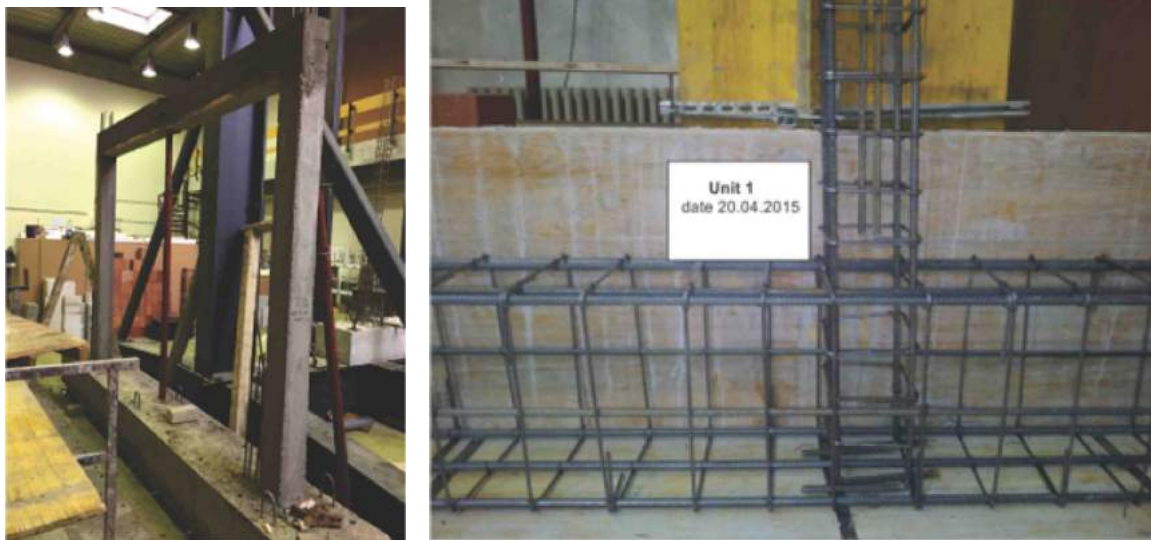
Fig.6.2, a) Rama betonarme e përgatitur për shqyrtim, b) detaji i lidhjes së shtyllës me themelin
