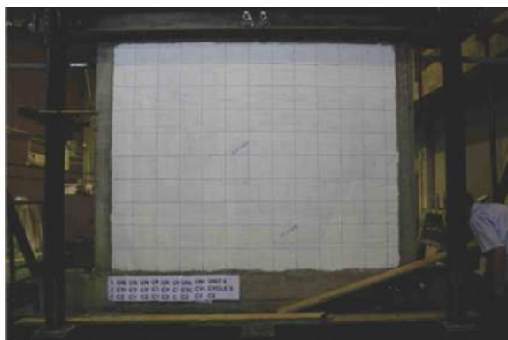
Fig.7.17 Rama me mbushje murature dhe vartësia forcë-zhvendosje, cikli 5
