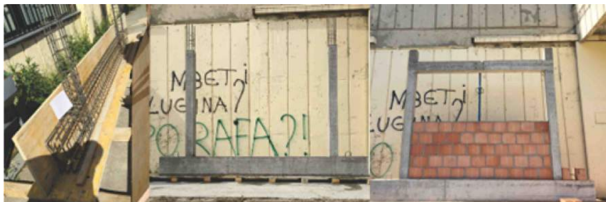
Fig.6.14 Përgatitja e modelit 7 nëpër faza të ndryshme
