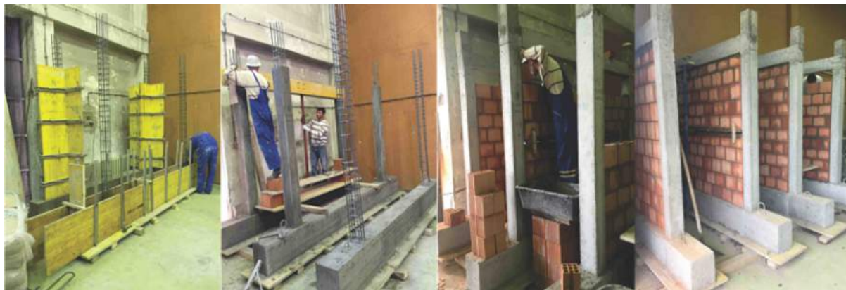
Fig.6.4 Përgatitja e modelit 2 nëpër faza të ndryshme
