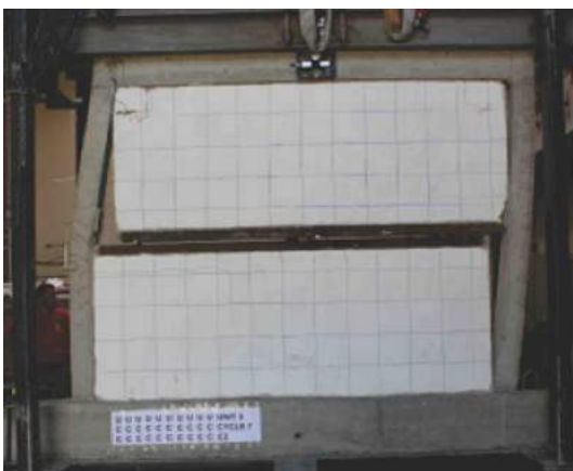
Fig.5.6 Krahasimet midis rezultateve (rezistencës dhe mekanizmit të thyerjes) të modelit llogaritës dhe modelit 3 të shqyrtuar
