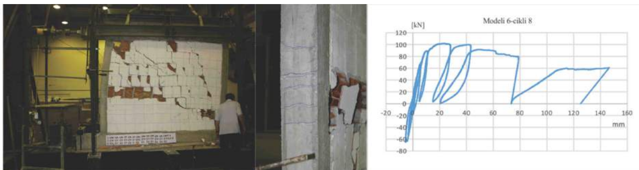
Fig.7.19, a) Degradimi i mbushjes me muraturë dhe i shtyllave, cikli 7. b)Mekanizmi i fundit i thyerjes dhe vartësia forcë-zhvendosje për të gjitha ciklet
