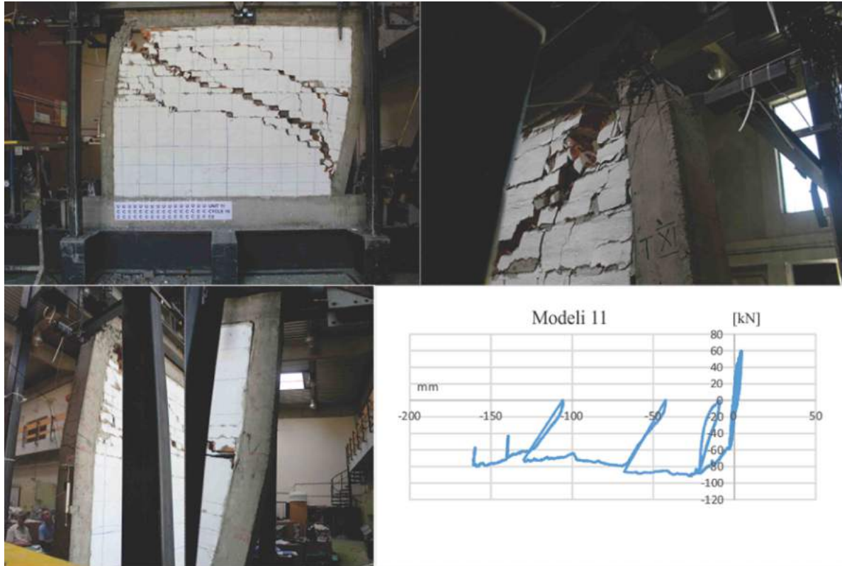
Fig.7.40 Mekanizmi i fundit, dëmtimet në mbushjen muraturë, shtyllat dhe nyjët dhe vartësia forcë zhvendosje për modelin e 11
