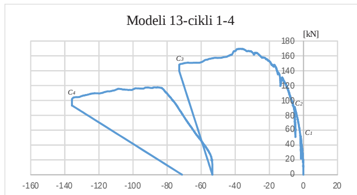
Fig.7.43 Niveli i forcës dhe zhvendosjeve të aplikuara në modelin 13
