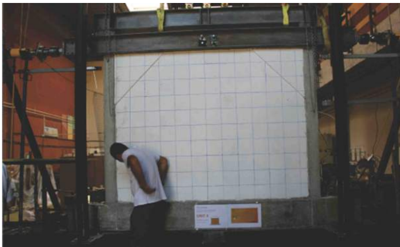
Fig.7.11 Modeli i 4 para testimit
