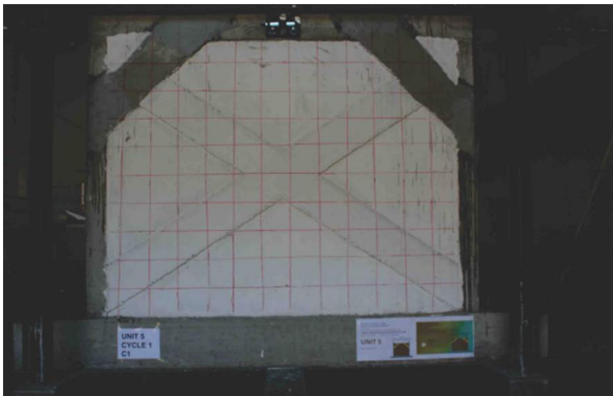
Fig.7.14 Mënyra e përforcimit dhe përgatitja e modelit 5 për shqyrtim
