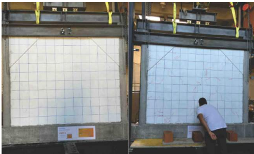
Fig.7.12 Modeli 4 nëpër fazën fillestare të ngarkimit
