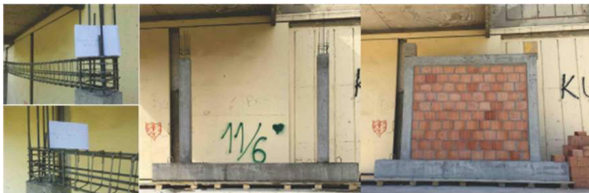
Fig.6.16 Përgatitja e modelit 8 nëpër faza të ndryshme
