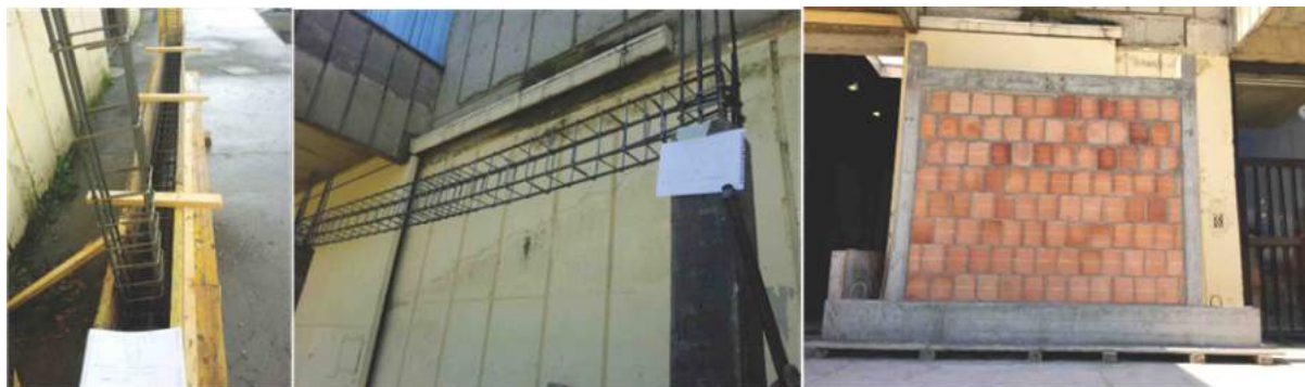
Fig.6.12 Përgatitja e modelit 6 nëpër faza të ndryshme
