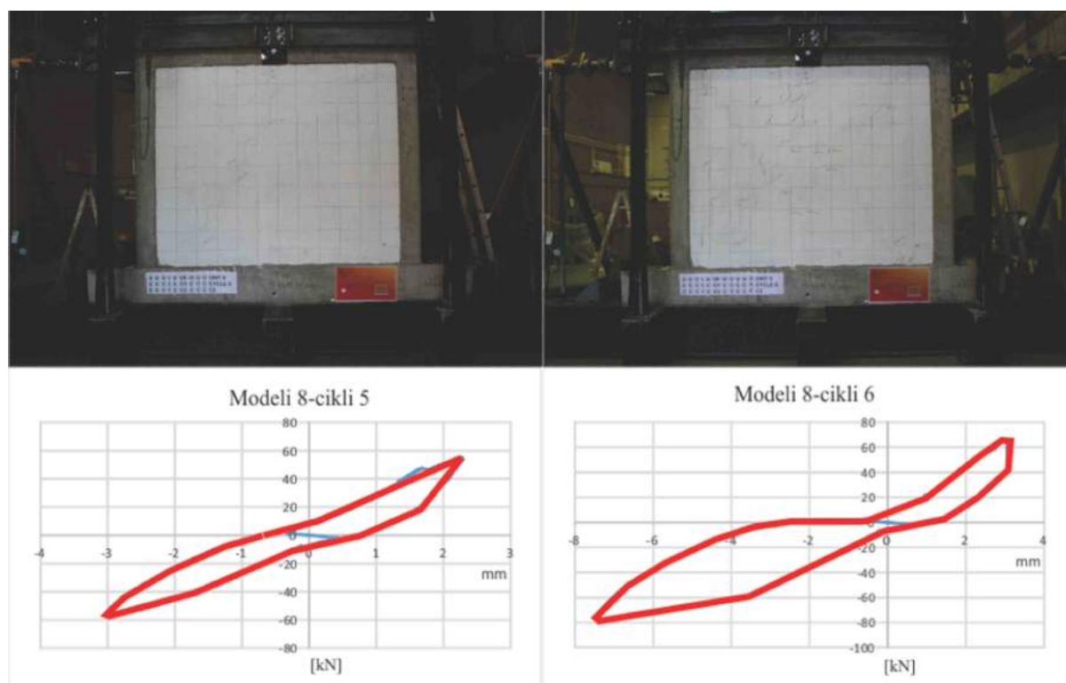
Fig.7.26 Rama me mbushje muraturë dhe vartësia forcë-zhvendosje, cikli 5 dhe 6
