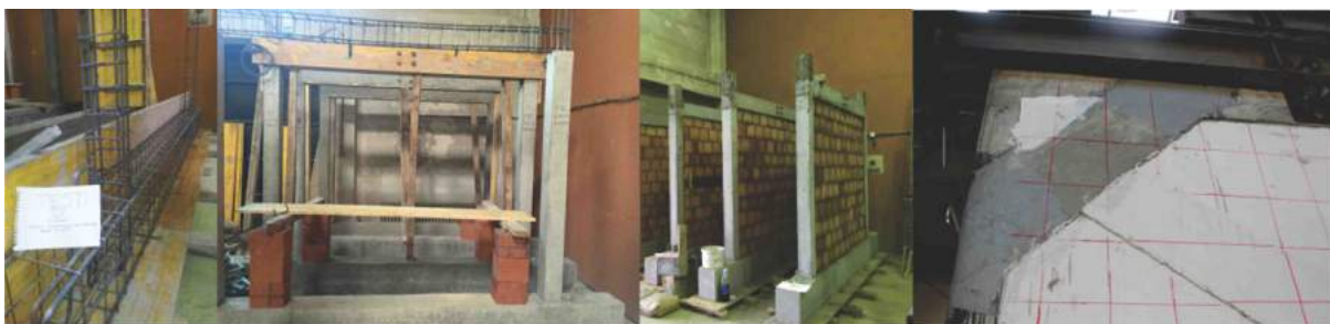
Fig.6.10 Përgatitja e Modelit 5 nëpër faza të ndryshme
