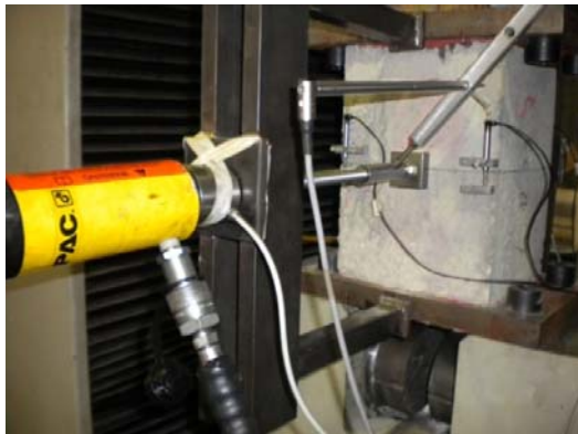
Figura 60: Instrumentimi i sistemit dhe emërtimi i kampionëve dhe ankerave.
