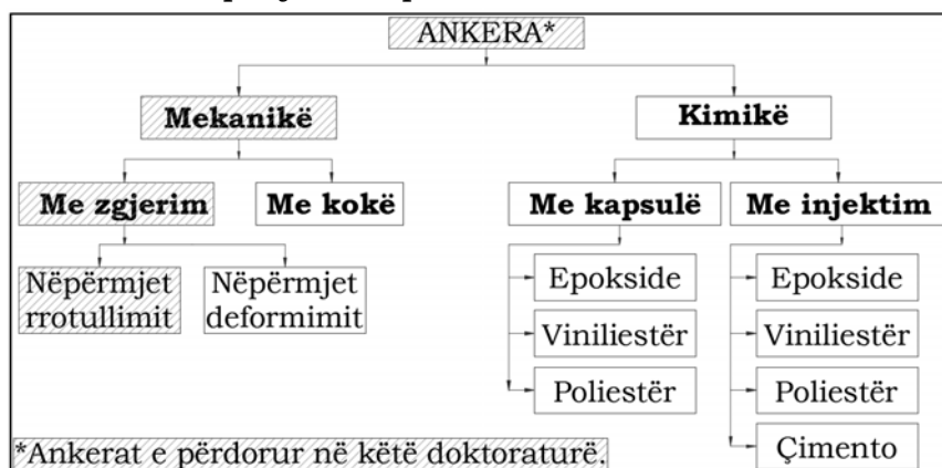
Figura 8: Klasifikimi i ankerave [3]
