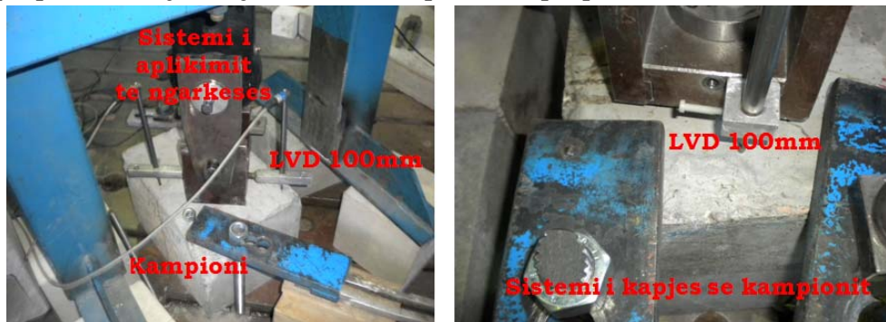
Figura 158: Montimi i ankerave dhe instrumentimi i provës për kampionin 11.
