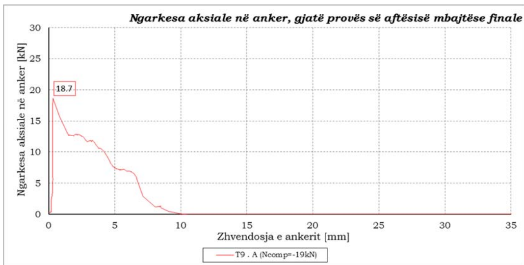
Figura 144: Aftësia mbajtëse finale e ankerit [T9.A].
