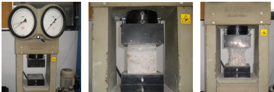
Figura 49: Provat në shtypje të kryera mbi kubet e betonit.
