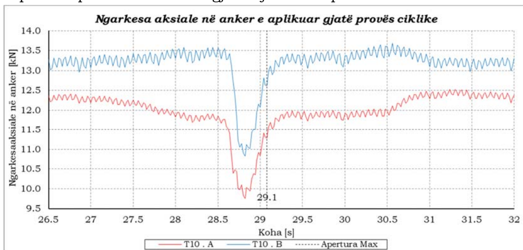
Figura 150: Ecuria e ngarkesës aksiale tërheqëse gjatë një cikli të provës ciklike e monitoruar nëpërmjet dinamometrave BTH 100 dhe ANK 100, në funksion të kohës.
