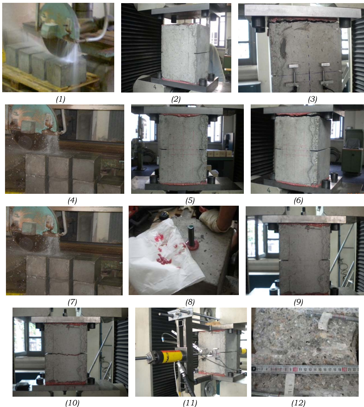
Figura 57: Imazhe të tentativave të ndryshme për krijimin e plasaritjes në kampionin e betonit.
