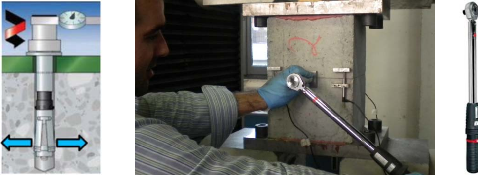
Figura 22: Shtrëngimi shkaktton zgjerimin e ankerit.
