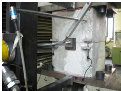
Figura 56: Instrumentimi i sistemit të provës për vlerësimin e aftësisë mbajtëse finale të ankerave.
