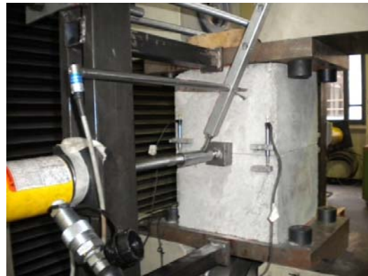
Figura 60: Instrumentimi i sistemit dhe emërtimi i kampionëve dhe ankerave.
