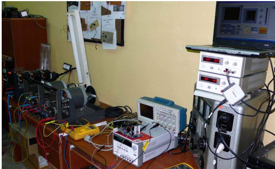
Fig. 4.14. Pamje nga zhvillimi i eksperimentit të testimit të sistemit të kontrollit të shpejtësisës të MRVEPav. 8211
