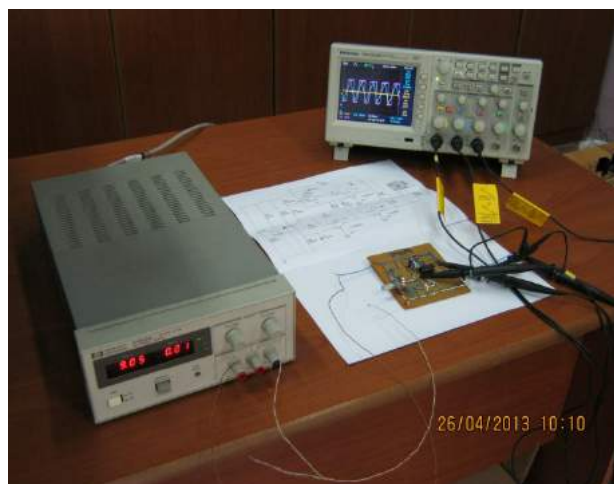
Fig. 2.22. Eksperimenti i MGJI-së me f=20\text{kHz}
