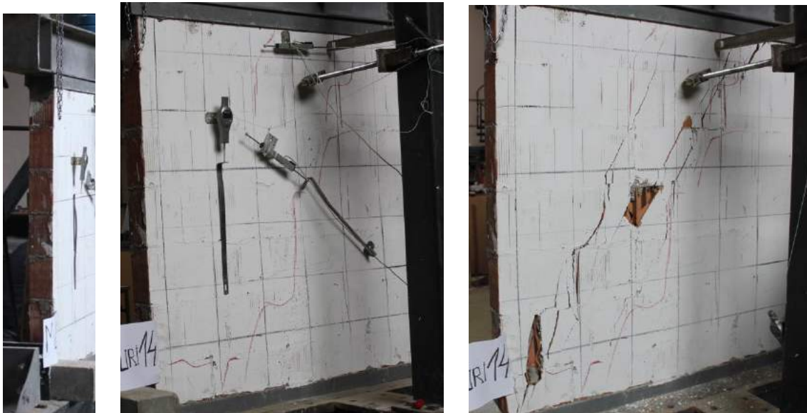
Fig. 5.3.63 Foto nga ekzaminimi i MTP14 pozita e ulmatsve dhe LVDTdhe plasaritja diagonale
