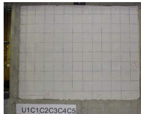
Fig. 5.4.5 Foto nga ekzaminimi i R BA 1 gjendja deri në ciklin e 3 pa demtuar – dhe plasaritjet në perimetrin e murit – kontakt me ram pas ciklit 5
