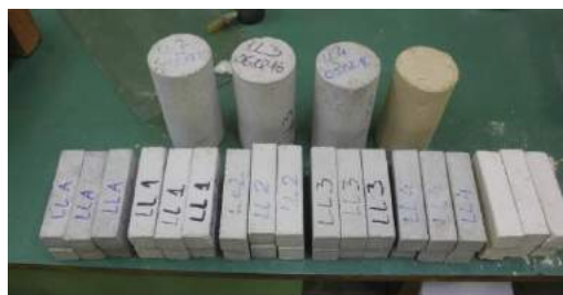
Fig 4.4.3 Mostra e prizmeve të llaçit në kallup dhe gjatë mirëmbajtjes
