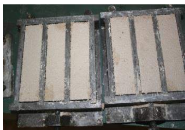
Fig 4.4.3 Mostra e prizmeve të llaçit në kallup dhe gjatë mirëmbajtjes
