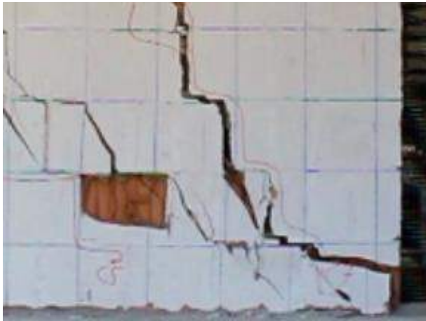
Fig. 5.4.60 Foto nga ekzaminimi i R BA 5 gjendja e plasaritjeve në deformimin maksimal si dhe pas kthyerjes se deformimeve elastike
