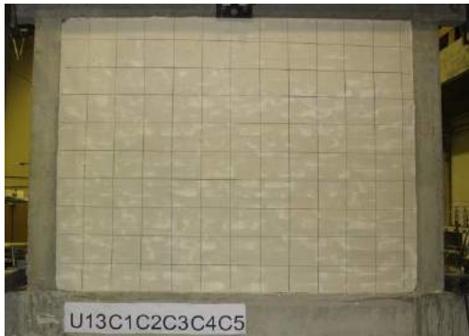
Fig. 5.4.17 Foto nga ekzaminimi i R BA 2 gjendja e e palasartur deri në ciklin e 5 dhe paraqitja e plasaritjeve fillestare në ciklin e 6
