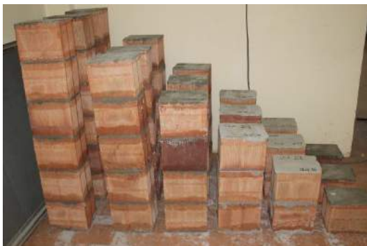
Fig.4.3.12 Foto të elementeve të përgaditura për ekzaminimin e numrit të bllokave 1-6 rende
