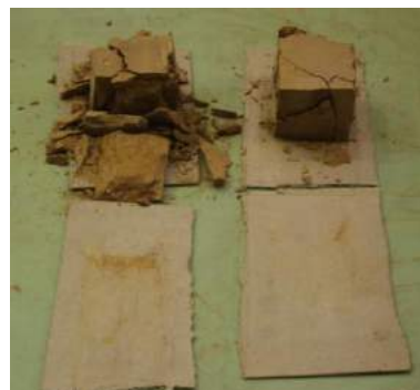
Fig 4.3.2 Forma të thyerjes së tullave më dimensione të ndryshme
