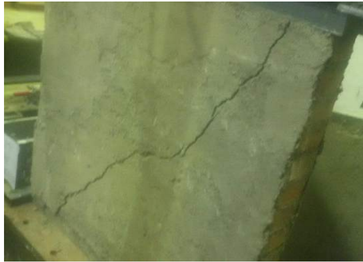
Fig. 5.3.35 Foto nga ekzaminimi i MTP 9 nga tullat të suvatosur me llaç me mikrofibrimë , vendosja e ulmatësave dhe plasaritj diagonale
