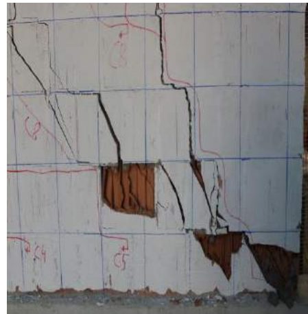
Fig. 5.4.60 Foto nga ekzaminimi i R BA 5 gjendja e plasaritjeve në deformimin maksimal si dhe pas kthyerjes se deformimeve elastike
