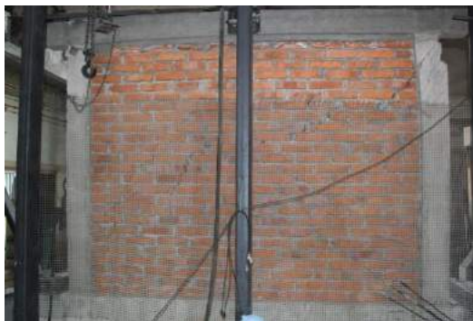
Fig. 5.4.6 Foto nga ekzaminimi i R BA 1 plasaritjet në diagonale prapa dhe në diagonalen lartë
