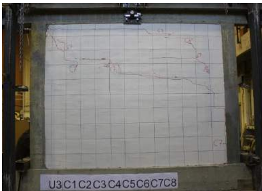
Fig. 5.4.31 Foto nga ekzaminimi i R BA 3 vazhdimi i rritjes plasaritjeve pas ciklit 8 si dhe gjendja e plasaritjeve pas ciklit 11
