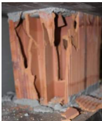
Fig. 4.3.11 Foto të elementeve më blloka 12 të Maminas të shqyrtuara, me një rend më vrima vertikal dhe me një rend me vrima horizontal
