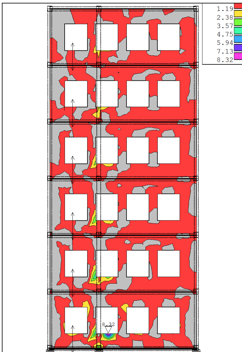
Fig 7. 6 Izometria e strukturës objektit – muri H 24 dhe diagrama e nderjeve saj
