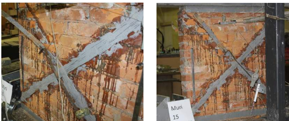
Fig. 5.3.69 Foto nga ekzaminimi i MTP15 plasaritjet në diagonale si dhe delamelimi i shiritave me fije të qelqit
