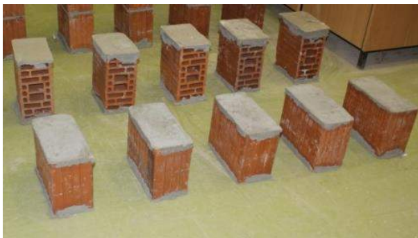
Fig.4.3.10 Foto të elemteve më blloka 12 të Landovices të shqyrtuara, me një rend më vrima vertikal dhe më një rend më vrima horizontal
