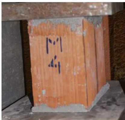
Fig. 4.3.11 Foto të elementeve më blloka 12 të Maminas të shqyrtuara, me një rend më vrima vertikal dhe me një rend me vrima horizontal
