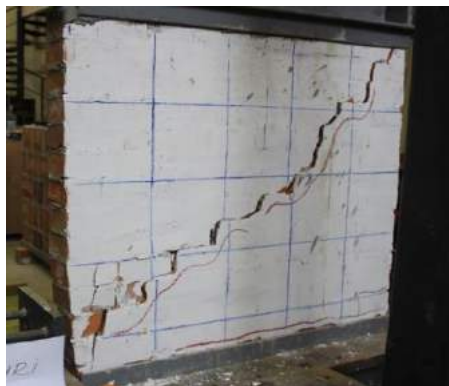
Fig. 5.3.16 Foto nga ekzaminimi i MTP 5, montimi i paisjeve si dhe plasaritja frontale- diagonale
