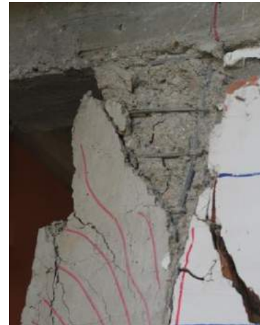
Fig. 6.8 Foto nga ekzaminimi i R BA 3 gjendja e plasaritur dhe nyja plastike në shtyllë
