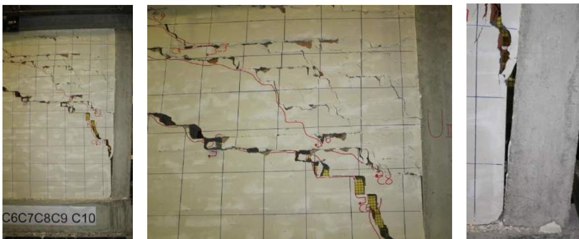
Fig. 5.4.21 Foto nga ekzaminimi i R BA 2 plasaritjet ka maje e murit diagonale në gjysmen e nalta të murit
