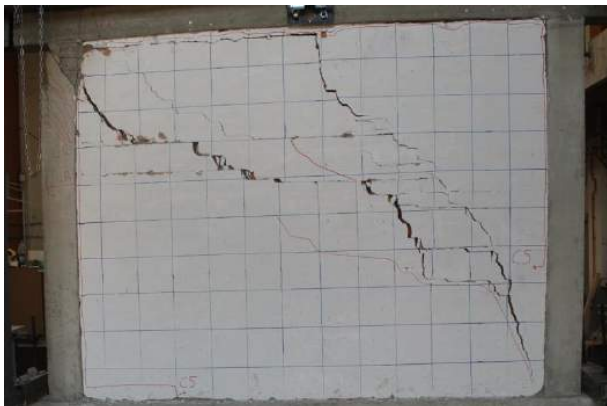
Fig. 6.12 Foto nga ekzaminimi i RBA 1 krahas ramit U 11 ndikimi i rezistencës shtyllave në sjelljen e murit
