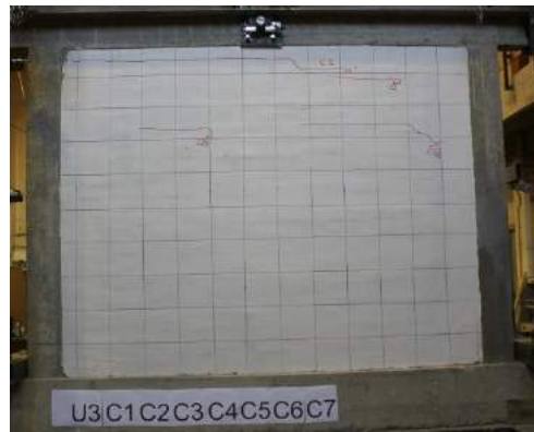
Fig. 5.4.30 Foto nga ekzaminimi i R BA 3 muri deri në ciklin e 4 pa plasaritje si dhe plasaritjet e para pas ciklit 7
