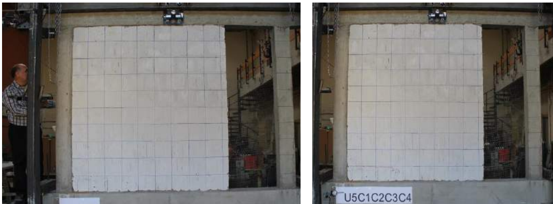
Fig. 5.4.56 Foto nga ekzaminimi i R BA 5 gjendja deri me ciklin e 3 dhe plasaritjet e para në ciklin 4
