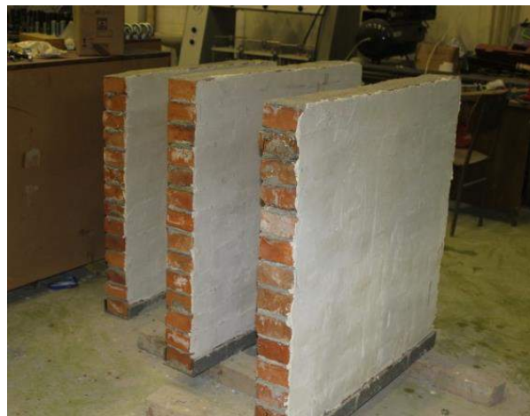
Fig 5.2.3 Muret e lira nga bllokat dhe tullat me dimensione t1.5*1.4 gjegjësisht 1.5*1.5 si dhe 3 muret me tulla 1*1
