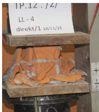
Fig 4.4.11. Mostrat me 2 tulla për ekzaminim në shtypje para thyerjes dhe pas thyerjes
