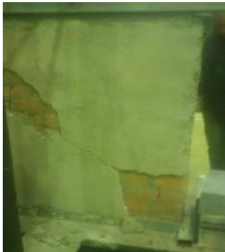
Fig. 5.3.36 Foto nga ekzaminimi i MTP 8 plasaritja dhe delamelimi i llaçit nga tullat ne skajet e diagonales
