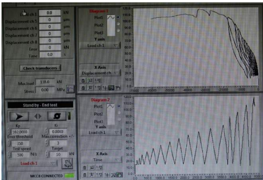
Fig 5.4.54 Foto e diagramit gjatë aplikimit të ngarkesës RBA 4 , diarami forcë zhvendosje dhe forcë kohe , fotografuar softveri nga MCC 8 multitest
