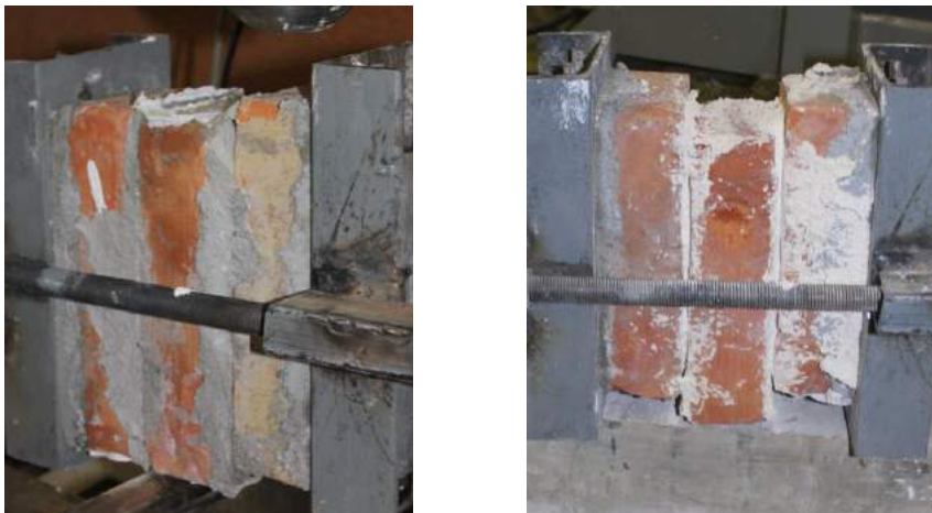
Fig. 4.4.17 Mostra e thyer pas veprimit të forcës në triplet
