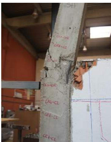
Fig. 5.4.69 Foto nga ekzaminimi i ramit U 91 nga punim nga mr sc Arton Dautaj detalet e formimit qernjerave plastike në shtyllat e R BA
