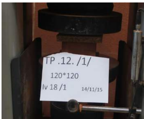
Fig4.8 Thyerja e tullave (120x 120 x60)mm në shtypje më iveric 18mm dhe lesomit 4mm
