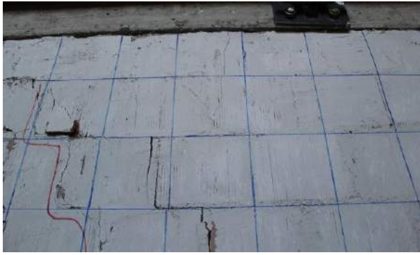
Fig. 5.4.59 Foto nga ekzaminimi i R BA 5 gjendja e plasarit tek muri diagonale – përgjat fugave vertikale dhe horizontale-
