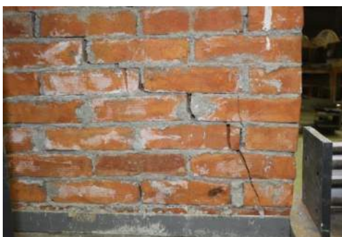
Fig. 5.3.18 Foto nga ekzaminimi i MTP 5 , diagonales shtypur poshtë - maja e murit nga të dyja anët
