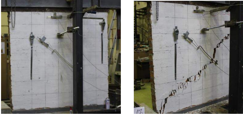
Fig. 5.3.57 Foto nga ekzaminimi i MTP13 pozita e ulmatsve dhe LVDT dhe plasaritja diagonale
