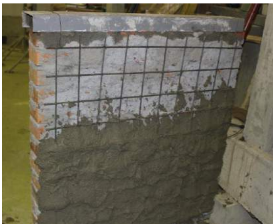
Fig 5.2.3 Muret e lira nga tullat me dimensione 1*1 të suvatosur me rrjet si dhe përforsuar me diagonale me fije të qelqit
