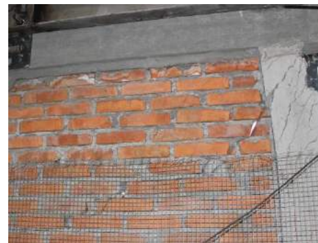
Fig. 5.4.6 Foto nga ekzaminimi i R BA 1 plasaritjet në diagonale prapa dhe në diagonalen lartë
