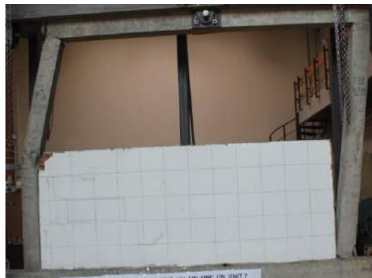
Fig. 6.11 Foto nga ekzaminimi i RBA 1 krahas ramit U 7 ndikimi i murit parapet në shtyllat e ramit – formimi i çernjerave plastike
