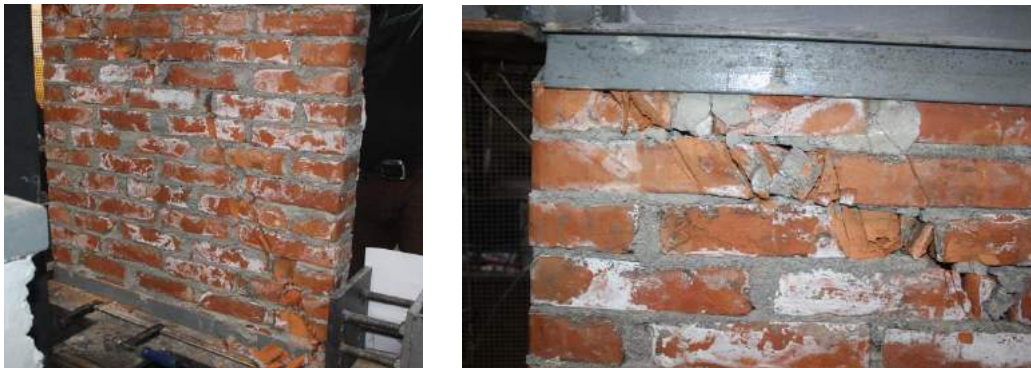
Fig. 5.3.5 Foto nga ekzaminimi i MTP 1 plasaritja në diagonale dhe këndin e sipërm
