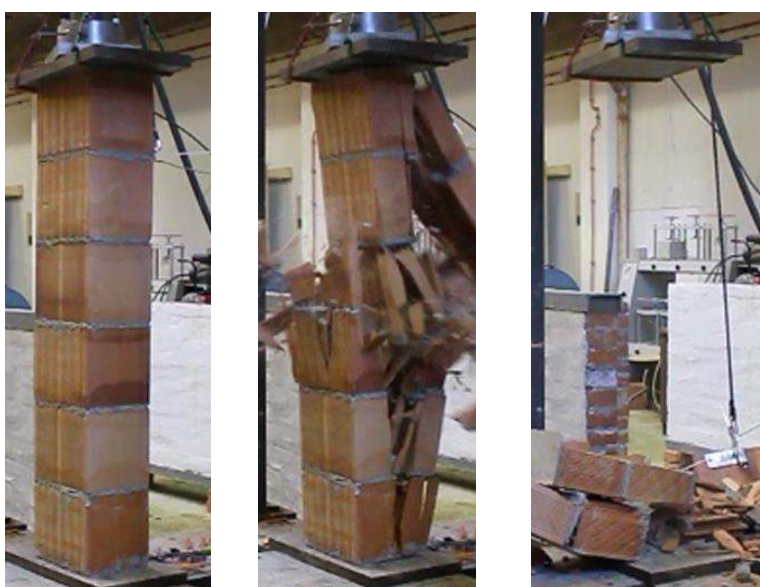
Fig. 4.3.17 3 Sekuencat e thyerjes rastit më 6 blloqe
