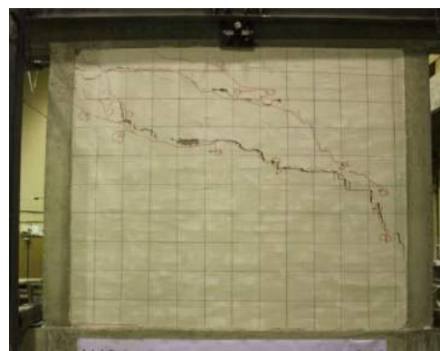
Fig. 5.4.18 Foto nga ekzaminimi i R BA 2 plasritjet pas ciklit 8 – majtas dhe pas ciklit 9 djathtas
