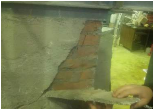
Fig. 5.3.36 Foto nga ekzaminimi i MTP 8 plasaritja dhe delamelimi i llaçit nga tullat ne skajet e diagonales
