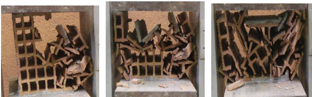
Fig 4.3.9 Foto të elemteve bllokut më vrima horizontale: forca vepron normal në zbrastësira : pas thyerjes
