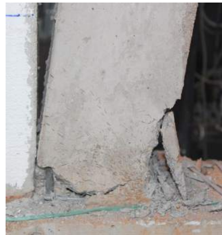
Fig. 5.4.69 Foto nga ekzaminimi i ramit U 91 nga punim nga mr sc Arton Dautaj detalet e formimit qernjerave plastike në shtyllat e R BA
