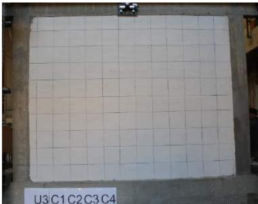
Fig. 5.4.30 Foto nga ekzaminimi i R BA 3 muri deri në ciklin e 4 pa plasaritje si dhe plasaritjet e para pas ciklit 7
