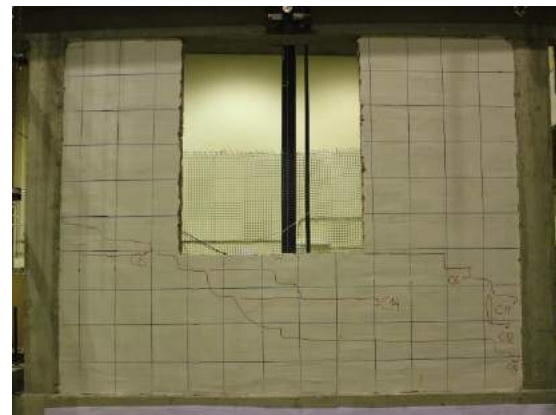
Fig 5.4.44 Foto nga ekzaminimi i R BA 4 gjendja e plasaritur pas ciklit të 13 dhe plasaritjet e pas ciklin e14
