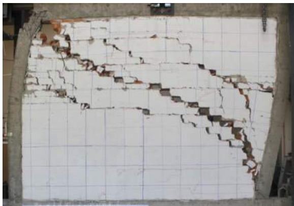
Fig. 6.12 Foto nga ekzaminimi i RBA 1 krahas ramit U 11 ndikimi i rezistencës shtyllave në sjelljen e murit
