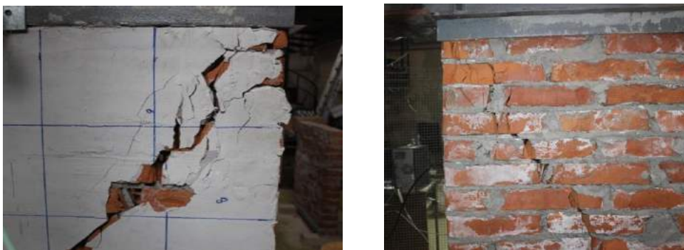
Fig. 5.3.12 Foto nga egzaminimi i MTP 4/Pjesa e sipërme e diagonale –majës së shkatëruar në shtypje
