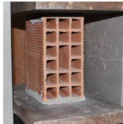
Fig. 4.3.11 Foto të elementeve më blloka 12 të Maminas të shqyrtuara, me një rend më vrima vertikal dhe me një rend me vrima horizontal
