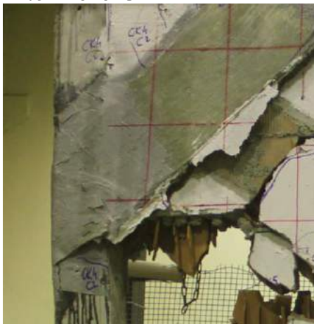
Fig. 5.4.73 Foto nga ekzaminimi i ramit U 11 nga punim nga Mr. Sc. Arton Dautaj detail I lidhjes pas shkatërrimit brezeve shiritore të leshit të qelqit me shtylla
