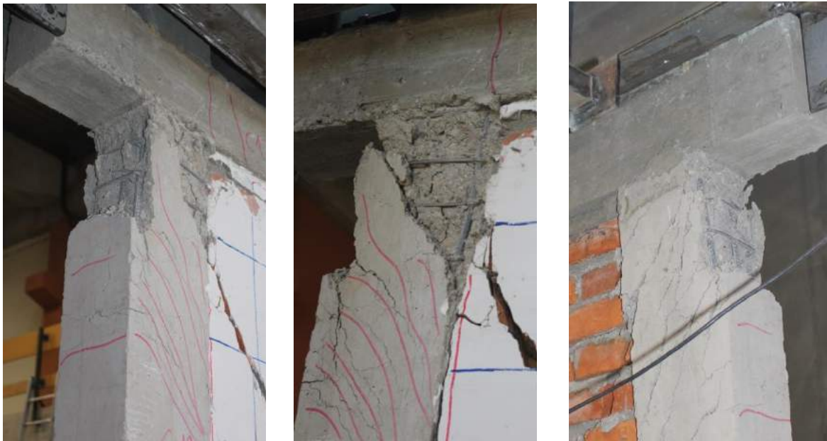
Fig. 5.4.8 Foto nga ekzaminimi i R BA 1 gjendja nyjes betonarme pas shkatrimit të murit
