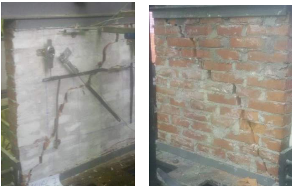
Fig. 5.3.25 Foto nga egzaminimi i MTP 7 diagonalja e thyrjes nga të dyja anët
