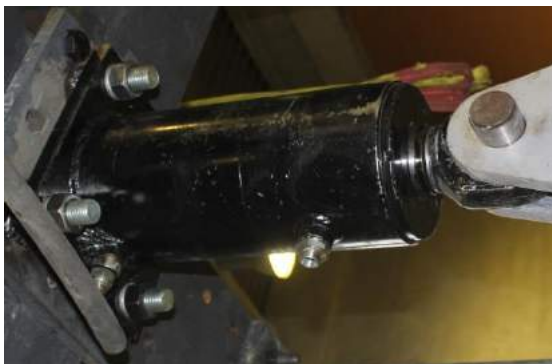
Fig. 5.1.3 Cilindri hidraulik 1000 kN ( majtas ) dhe cilindri hidraulik 500 kN me LC (load cell ) matësin e forcës 500 kN të montuar në kokën e tij
