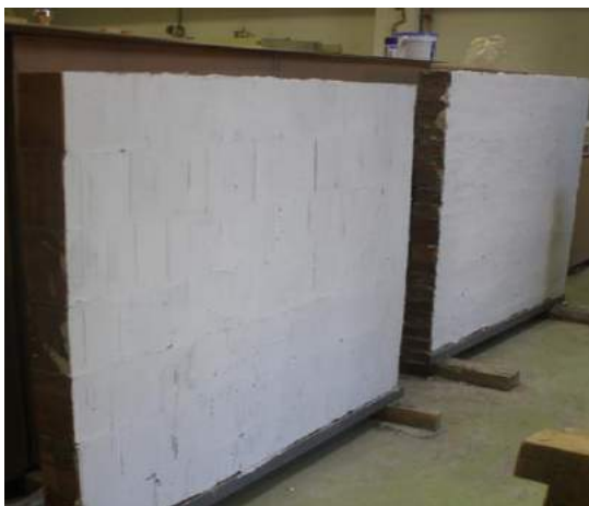
Fig 5.2.3 Muret e lira nga bllokat dhe tullat me dimensione t1.5*1.4 gjegjësisht 1.5*1.5 si dhe 3 muret me tulla 1*1
