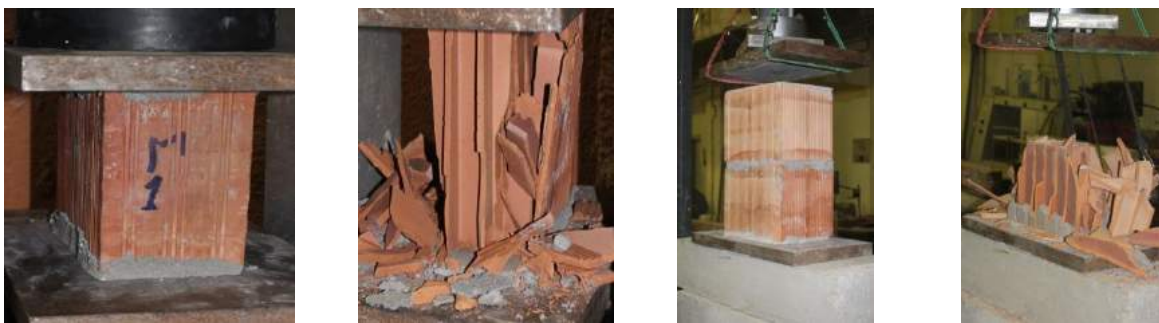
Fig. 4.3.13 Foto të blloqeve të vendosura në presa të shqyrtuara për këto raste
