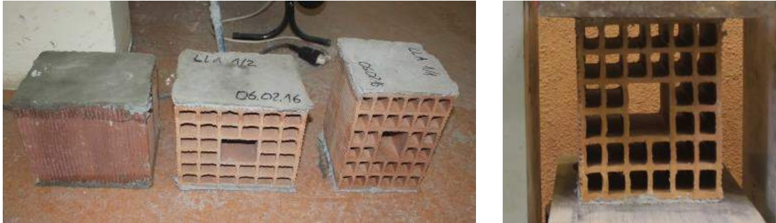
Fig. 4.3.8 Foto të elementeve bllokut në pozita më vrima vertikale dhe më vrima horizontale dy pozicione
