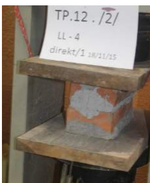
Fig 4.4.11. Mostrat me 2 tulla për ekzaminim në shtypje para thyerjes dhe pas thyerjes
