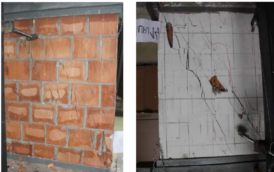
Fig. 5.3.64 Foto nga ekzaminimi i MTP14 diagonalja nga të dyja anët kryesore
