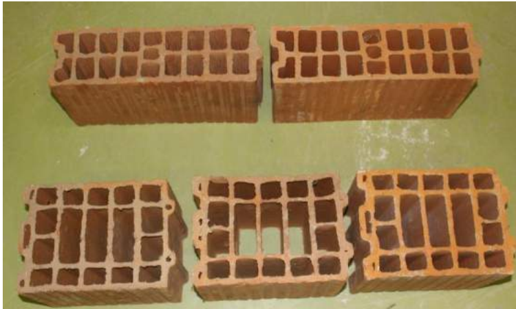
Fig. 2.4 Disa nga elementet e lehta me dhëmbëzim për ndërlidhje ( inklinim ) – prodhim vendor
