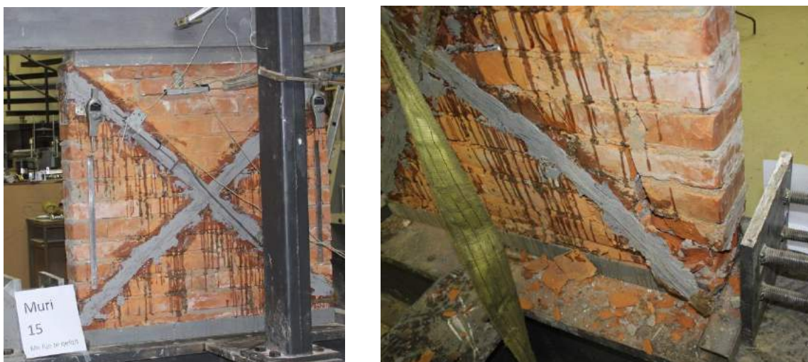
Fig. 5.3.68 Foto nga ekzaminimi i MTP15 pozita e ulmatsve dhe LVDT dhe plasaritja diagonale
