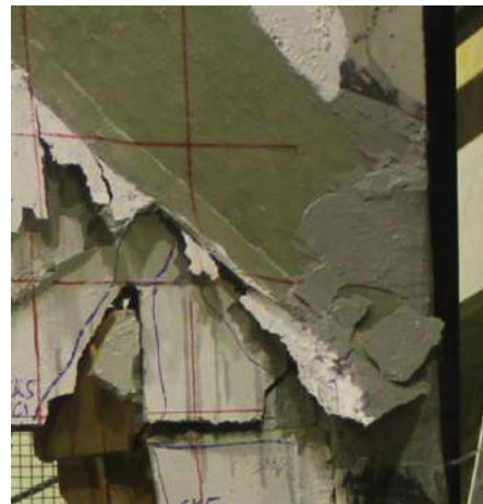
Fig. 5.4.73 Foto nga ekzaminimi i ramit U 11 nga punim nga Mr. Sc. Arton Dautaj detail I lidhjes pas shkatërrimit brezeve shiritore të leshit të qelqit me shtylla
