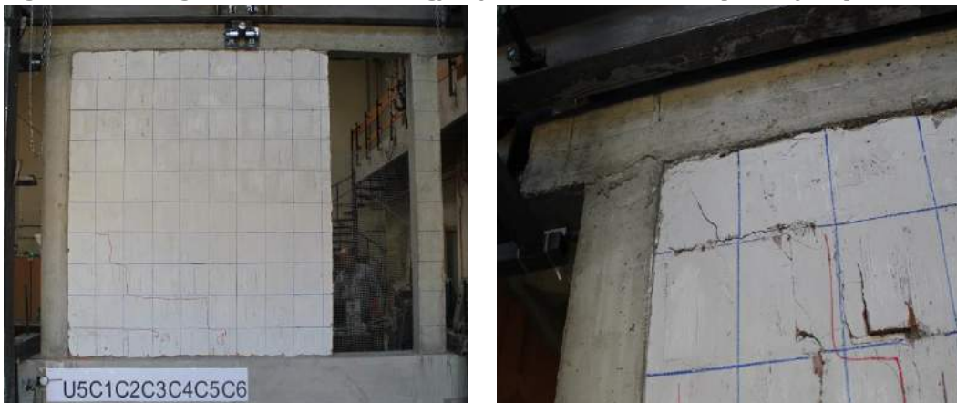
Fig. 5.4.57 Foto nga ekzaminimi i R BA 5 gjendja e plasaritjeve pas ciklit 6 dhe plasaritjet në nyjen e shtypur në mure
