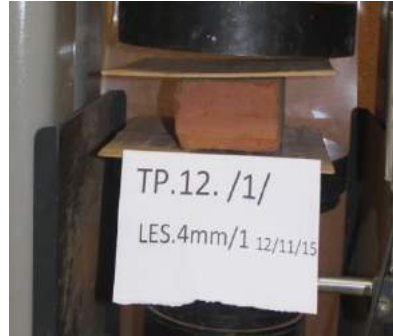
Fig4.7 Thyerja e tullave (120 x 250 x 60)mm, në shtypje , rrafshhtësimi më iveric 18mm dhe lesomit 4mm
