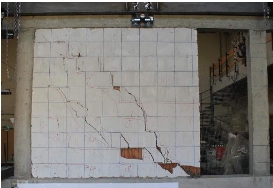
Fig. 5.4.58 Foto nga ekzaminimi i R BA 5 gjendja pas perfundimit te aftesis mbajttese – ciklit 8
