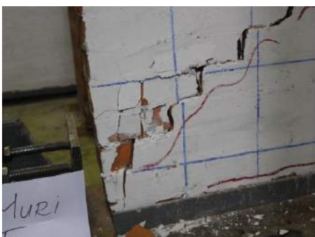
Fig. 5.3.18 Foto nga ekzaminimi i MTP 5 , diagonales shtypur poshtë - maja e murit nga të dyja anët
