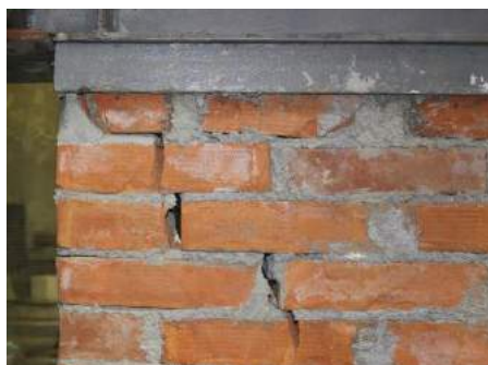
Fig. 5.3.17 Foto nga ekzaminimi i MTP 5, diagonales shtypur lartë nga të dyja anët
