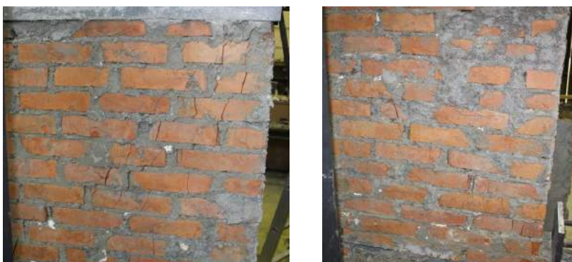
Fig. 5.3.42 Foto nga egzaminimi i MTP 10 plasaritjet brenda diagonaleve pal delamelimit
