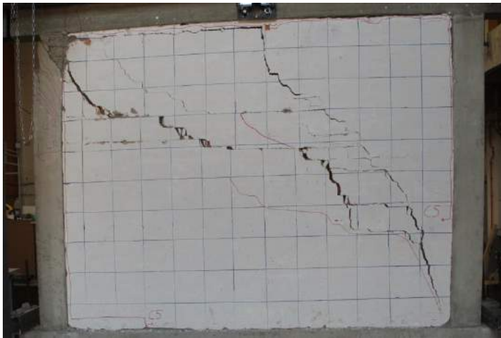
Fig. 6.8 Foto nga ekzaminimi i R BA 3 gjendja e plasaritur dhe nyja plastike në shtyllë
