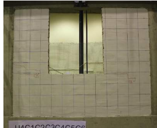
Fig. 5.4.43 Foto nga ekzaminimi i R BA 4 gjendja e pa plasaritje deri ciklin e 4 dhe plasaritjet pas ciklit e 5
