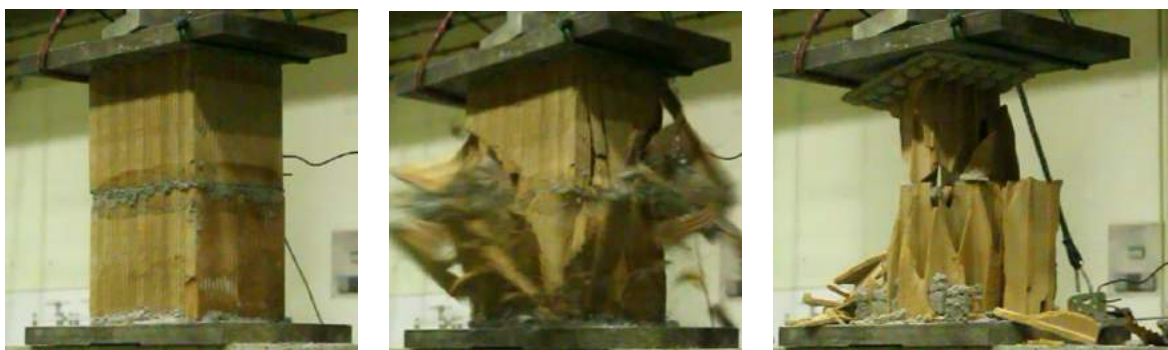
Fig 4.3.15 3 Sekuencat e thyerjes rastit më 2 blloqe
