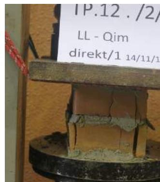
Fig 4.4.11. Mostrat me 2 tulla për ekzaminim në shtypje para thyerjes dhe pas thyerjes
