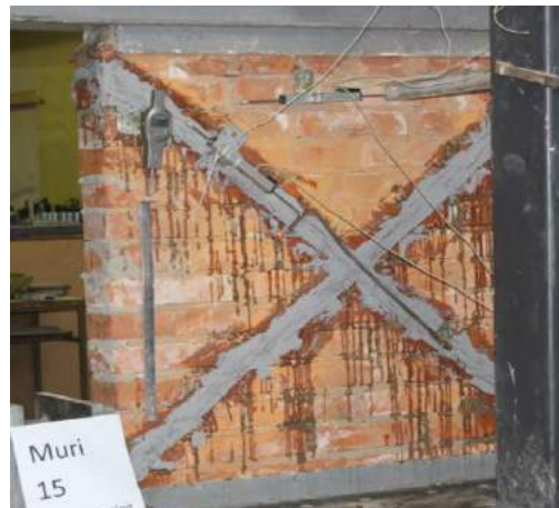
Fig 5.2.3 Muret e lira nga tullat me dimensione 1*1 të suvatosur me rrjet si dhe përforsuar me diagonale me fije të qelqit
