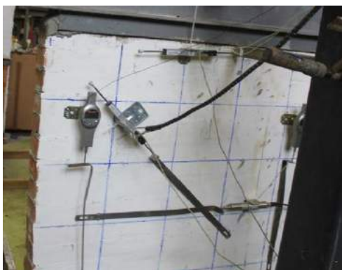
Fig. 5.3.16 Foto nga ekzaminimi i MTP 5, montimi i paisjeve si dhe plasaritja frontale- diagonale
