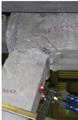
Fig. 5.4.69 Foto nga ekzaminimi i ramit U 91 nga punim nga mr sc Arton Dautaj detalet e formimit qernjerave plastike në shtyllat e R BA
