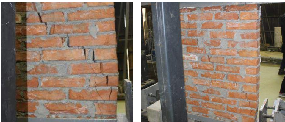
Fig. 5.3.53 Foto nga ekzaminimi i MTP 12 plasaritjet në majën e elementit i diagonalja poshët
