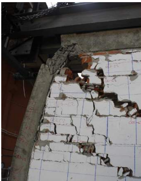
Fig. 5.4.71 Foto nga ekzaminimi i ramit U 11 nga punim nga Mr. Sc. Arton Dautaj detail I shtyllave shkatërruar pjesën e lartë të shtyllës si dhe pjesën e poshtme të shtyllës tjetër
