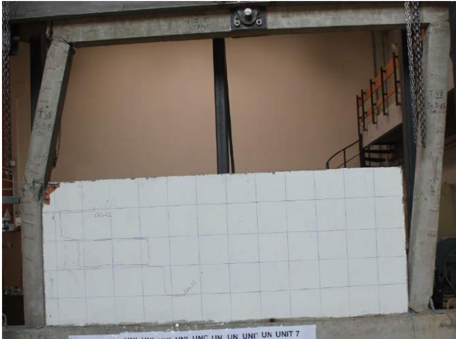
Fig. 5.4.68. Foto nga ekzaminimi i ramit U 7 nga punim nga Mr. Sc. Arton Dautaj muri i bllokave parapet dhe shtyllat e deformuara me këto raste
