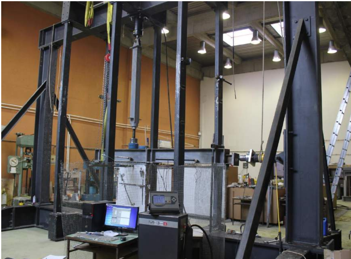
Fig. 5.2.1 Struktura metalike e adaptuar për thyerjen e mureve të lira dhe MCC 8
