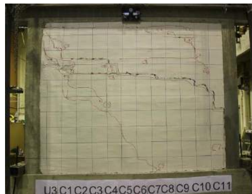
Fig. 5.4.31 Foto nga ekzaminimi i R BA 3 vazhdimi i rritjes plasaritjeve pas ciklit 8 si dhe gjendja e plasaritjeve pas ciklit 11
