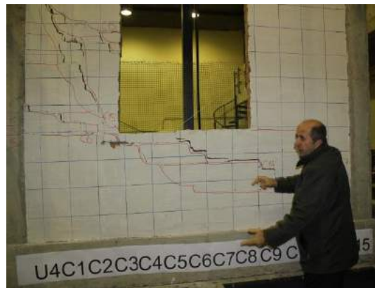
fig 5.4.46 Foto nga ekzaminimi i R BA 4 gjendja e plasarit në momentin e deformimeve maksimale dhe pas kthimit në gjendjen e deformimeve të mbetura
