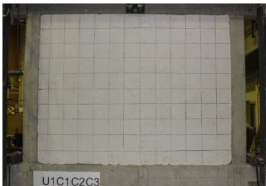
Fig. 5.4.5 Foto nga ekzaminimi i R BA 1 gjendja deri në ciklin e 3 pa demtuar – dhe plasaritjet në perimetrin e murit – kontakt me ram pas ciklit 5
