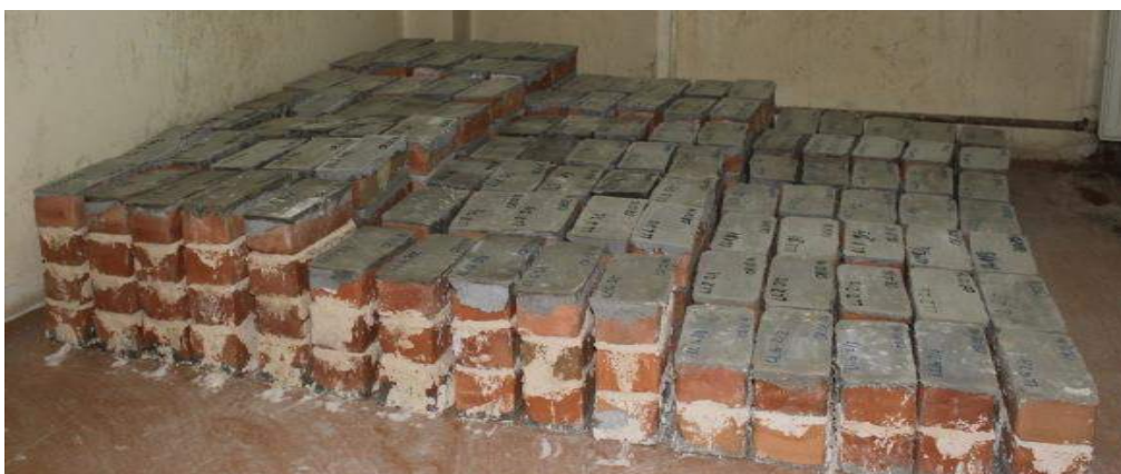
Fig 4.4.10 Mostra e përgaditura për 7 lloj llaçna :nga 5 sete nga 2 dhe 4 mostra për në shtypje si dhe nga 5 sete nga tri mostra për triplet- rrëshqitje
