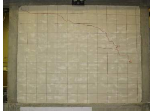
Fig. 5.4.17 Foto nga ekzaminimi i R BA 2 gjendja e e palasartur deri në ciklin e 5 dhe paraqitja e plasaritjeve fillestare në ciklin e 6
