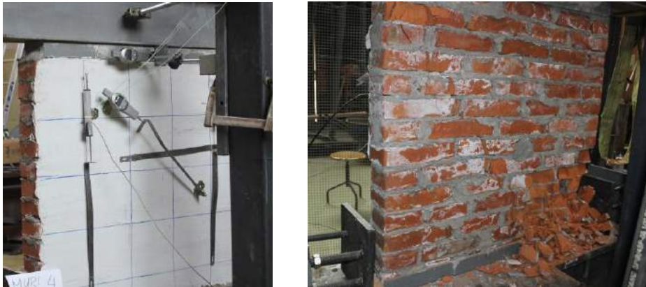
Fig. 5.3.10 Foto nga ekzaminimi i MTP foto para dhe pas thyerjes
