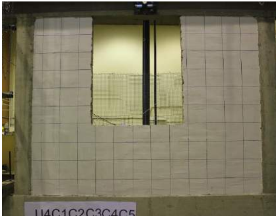
Fig. 5.4.43 Foto nga ekzaminimi i R BA 4 gjendja e pa plasaritje deri ciklin e 4 dhe plasaritjet pas ciklit e 5
