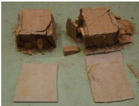
Fig 4.3.2 Forma të thyerjes së tullave më dimensione të ndryshme
