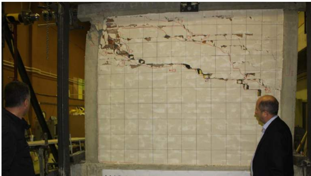
Fig. 5.4.19 Foto nga elzaminimi i R BA 2 gjendja e plasaritjeve pas humbjes sa aftësisë mbajtëse – ciklit 10
