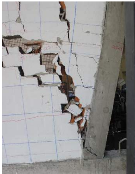
Fig. 5.4.71 Foto nga ekzaminimi i ramit U 11 nga punim nga Mr. Sc. Arton Dautaj detail I shtyllave shkatërruar pjesën e lartë të shtyllës si dhe pjesën e poshtme të shtyllës tjetër
