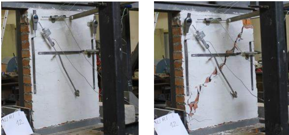
Fig. 5.3.51 Foto nga ekzaminimi i MTP12pozita e ulmatsve dhe LVDT dhe plasaritja diagonale
