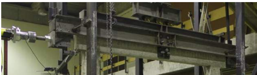
Fig. 5.4.3 Detalet e lidhjes së traut me poratabel të veprimit forcës portalin për forcë vertikale dhe portalin për forcë horizontale
