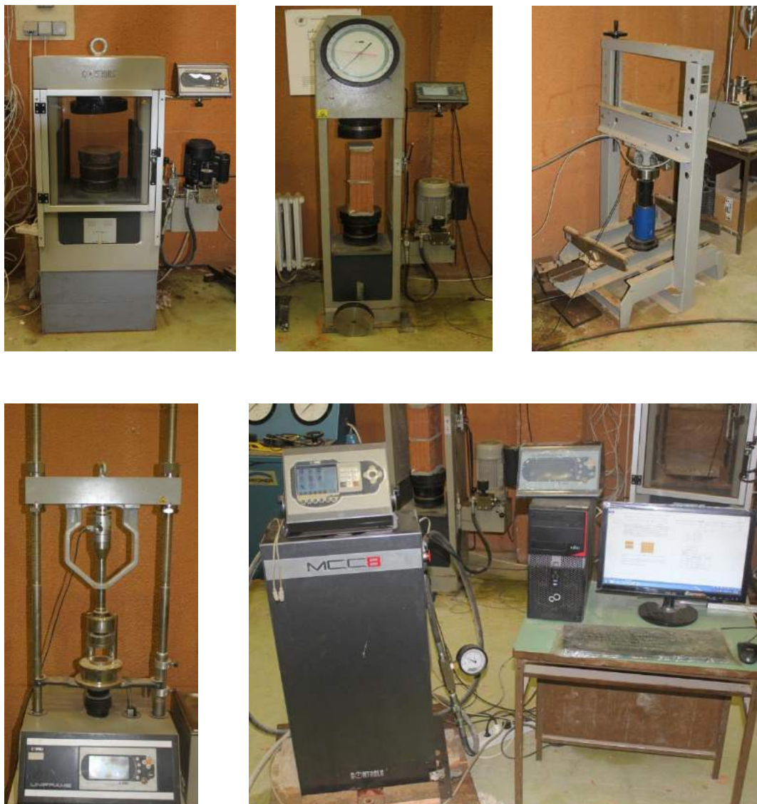
Fig 4.2 Paisjet për shqyrtimin e elementeve, presa 3000 kN, Presa 1000 /500kN, presa për lakim 150 kN , Uniframe dhe konzolla MCC8
