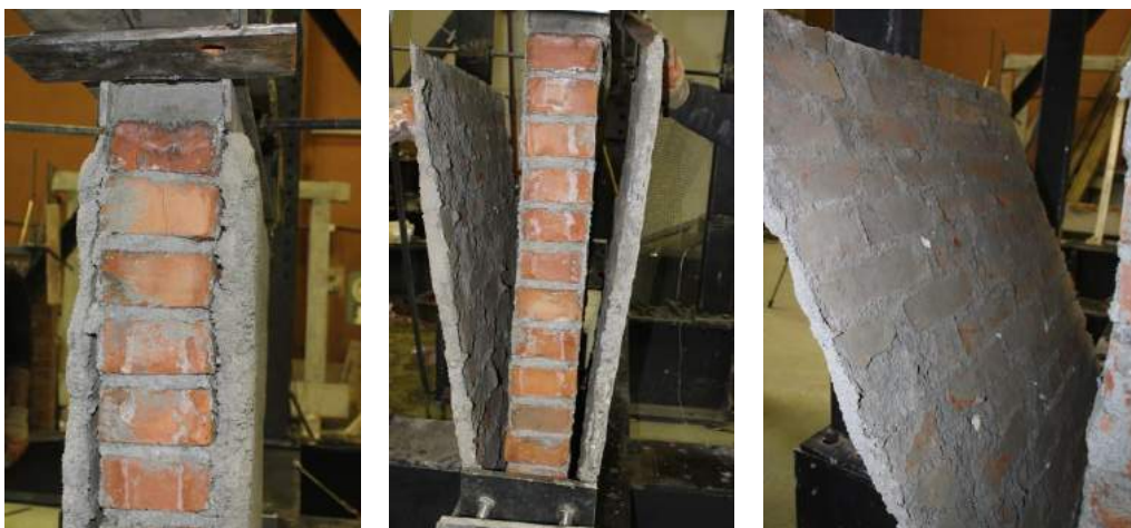
Fig. 5.3.41 Foto nga ekzaminimi i MTP10 delamelimi i llaçit
