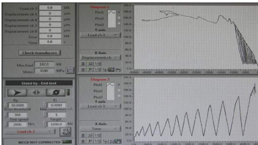
Fig 5.4.15 Foto e diagramit gjatë aplikimit të ngarkesës RBA 1 fotografuar softveri nga MCC 8 multitest
