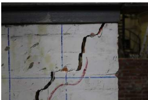
Fig. 5.3.17 Foto nga ekzaminimi i MTP 5, diagonales shtypur lartë nga të dyja anët
