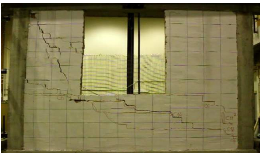
Fig 5.4.45 Foto nga ekzaminimi i R BA 4 gjendja e plasaritur pas humbjes së aftësis mbajtëse
