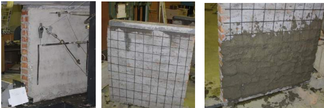
Fig. 5.3.40 Foto nga ekzaminimi i MTP10 pozita e ulmatsve dhe LVDT si dhe faza gjatë vendosjes rrjetës dhe suvatimit
