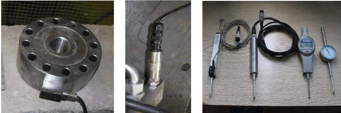
Fig. 5.1.4 Instrumente matse : LC 500 kN matsi i presionit 700 bar ( në mes) dhe ulmatsa kapacitetit 100 mm, 50 mm , digjital dhe klasik
