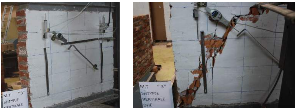
Fig. 5.3.4 Foto nga ekzaminimi i MTP 3 foto para dhe pas thyerjes
