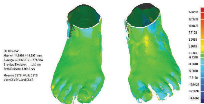
Figura 35. Rezultatet e krahasimit 3D ndërmjet Konica Minolta VIVID 910 dhe FlexScan.
