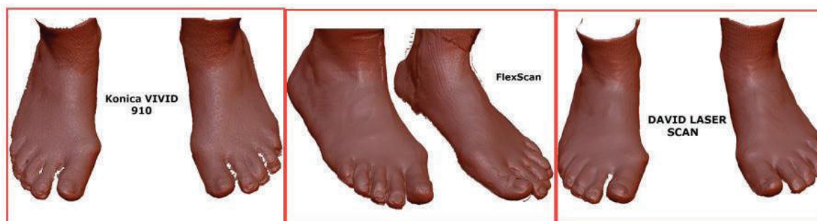
Figura 34. Modelet 3D të këmbëve të marra me tre sistemet e skanimit.
