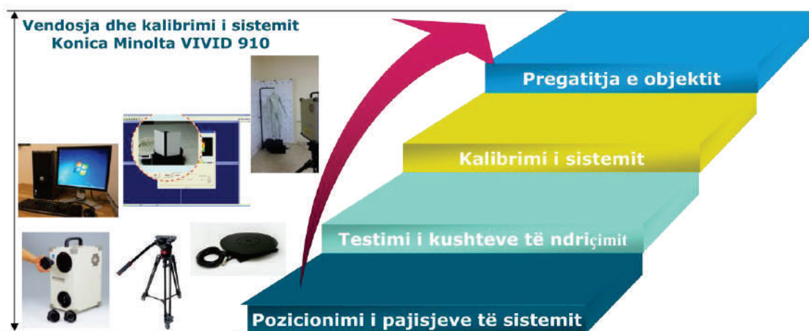
Figura 13. Etapat e vendosjes dhe kalibrimit të sistemit Konica Minolta VIVID 910.
