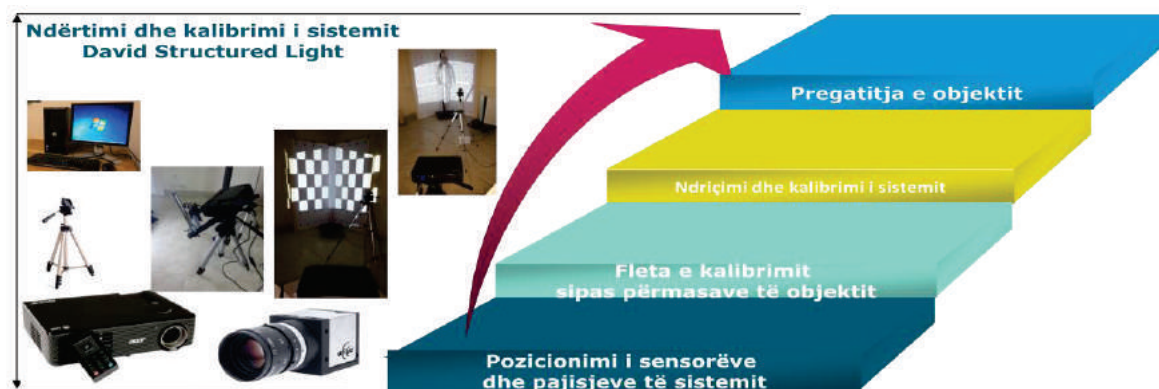
Figura 19. Etapat e ndërtimit dhe kalibrimit të sistemit David Structured Light.
