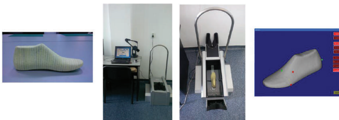
Figura 36. Sistemi i skanimit të këmbës INFOOT USB.
