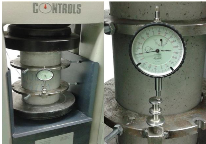
Figura 5.15. Matja e modulit elastik statik (leximi i deformimit gjatësor)
