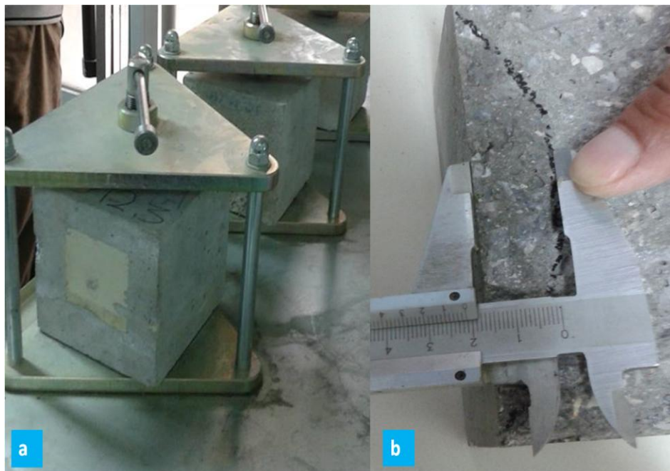
Figura 5.21. Testi i matjes së penetrimit të ujit në beton a) kampioni në sistemin e ujit nën shtypje 5 bar; b) leximi i thellësisë së depërtimit të ujit
