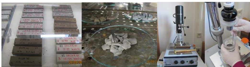
Figura 31: Hapat që ndiqen për pregatitjen e kampionit për karakterizimin mikrostrukturor: mbajtja nën ujë – procesi i tharjes - bluarja – imtësimi i materialit pas ngurtësimit
