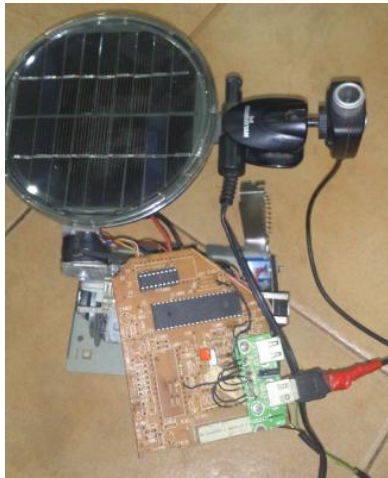
Fig. 4.1.3 Komandimi i panelit diellor prej kompjuterit nëpërmjet PIC18F4550-I/P Microchip Microcontroller & ULN2803
