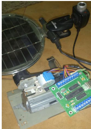
Fig. 4.1.4 Komandimi i panelit diellor prej kompjuterit nëpërmjet modulit Stepper-Bee
