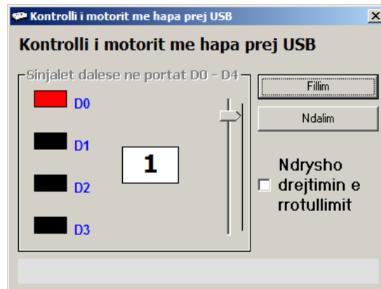
GUI për komandimin e motorit me hapa nëpërmjet PIC18F4450-I/P
