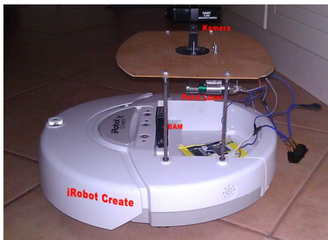
Fig 6.1. iRobot Create, kamera, gjeneruesi lazer dhe elementi BAM
