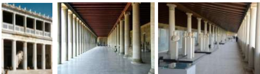
Figura 12. Stoja e Atalës në Athinë na ilustron fasadën me order të mbivendosur por me lartësi të ndryshme. Vëmë re në interior mënyrën e mbulimit të Stoaës me tavan të pjerrët në kat të dytë ndërsa me tavan të drejtë në kat të parë.
