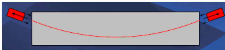
Figura 3.38 Terheqja e tendonit. Humbjet ne pykat fiksuese
