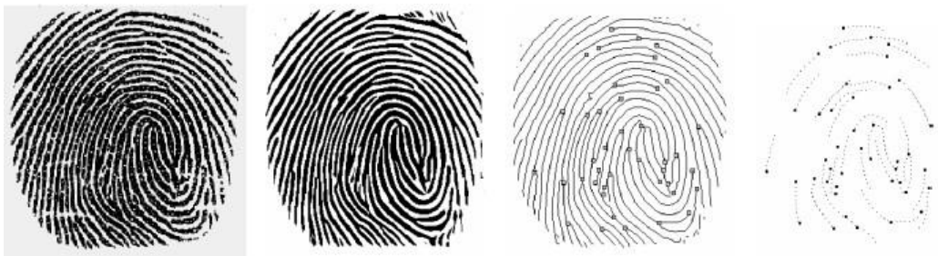
Figura 4-20. Procesi i qartësimit të imazhit dhe ekstraktimit të karakteristikave të gjurmës papilare
