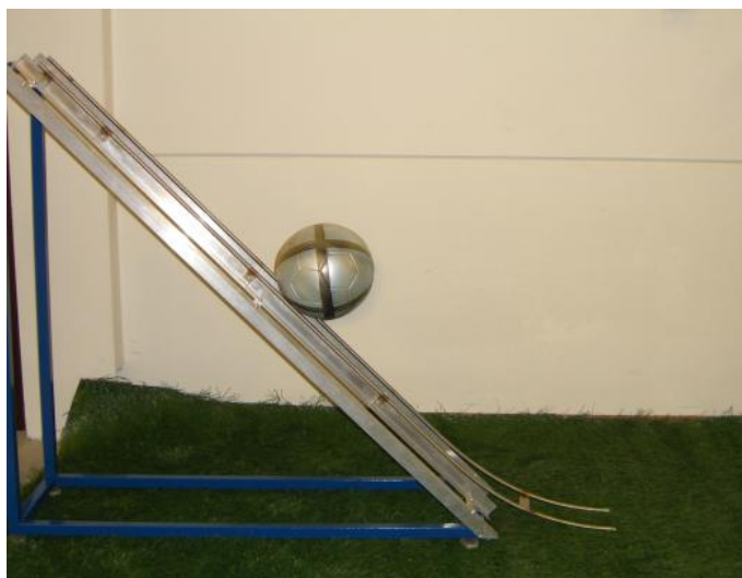
Figura 4.17. Pajisja e përdorur për të përcaktuar distancën e rrokullisjes së topit
