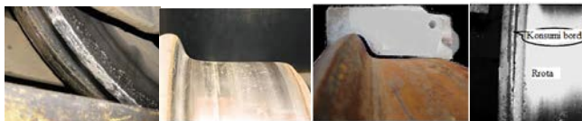
Fig.2. Defekte në sipërfaqet rrokullisëse të rrotave hekurudhore.
