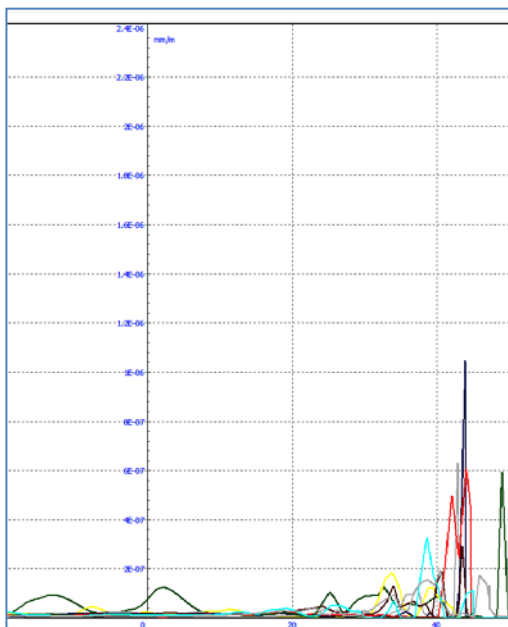
Figura.4.14.Epjura e konsumit specifik të rrotës së djathtë të aksit të parë mbasi ka përkthyer 76973 km,gjatë simulimit të çiftitdmeti30.wpf -r50new.rpf.Ngjyrat përkatëse korespondojnë me konsumin akumulativ, sipas kilometrave të përkthyer.( 10000,20000,30000,40000,50000,60000,70000 dhe 76973 kilometra.)
