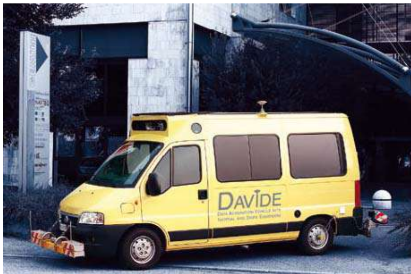
Figura 4.10 – Laborator Automobil per rilevim me rendiment të lartë “DAVIDE”
