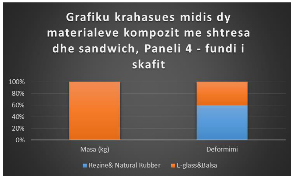
Fig. 112 – Grafiku krahasues midis dy materialeve kompozit me shtresa dhe sandwich
