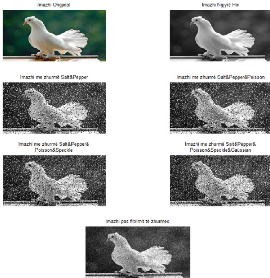
Figura 6.18. Rezultatet e fituara me aplikimin e filtrit Median
