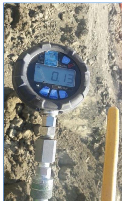
Fig 4.35, instalimi i valvulave dhe injektimi në seksion 0.13 bar
