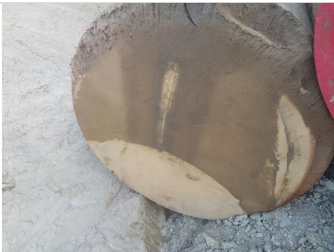
Fig 4.19, Pigu i parë i sapo dal nga tubacioni ,më shume se 3/4 e diametrit është e njome
