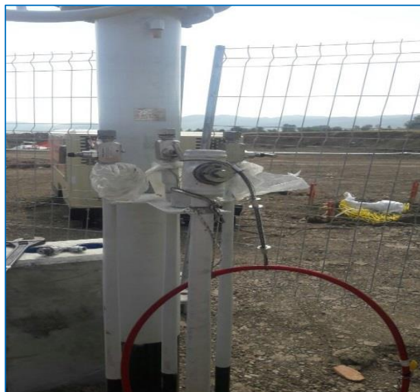
Fig.5.24, Testi në hermeticitet mbaroj (nuk kishte rënie presioni dhe uje nuk doli nga linja e shkarkimit 1”).
