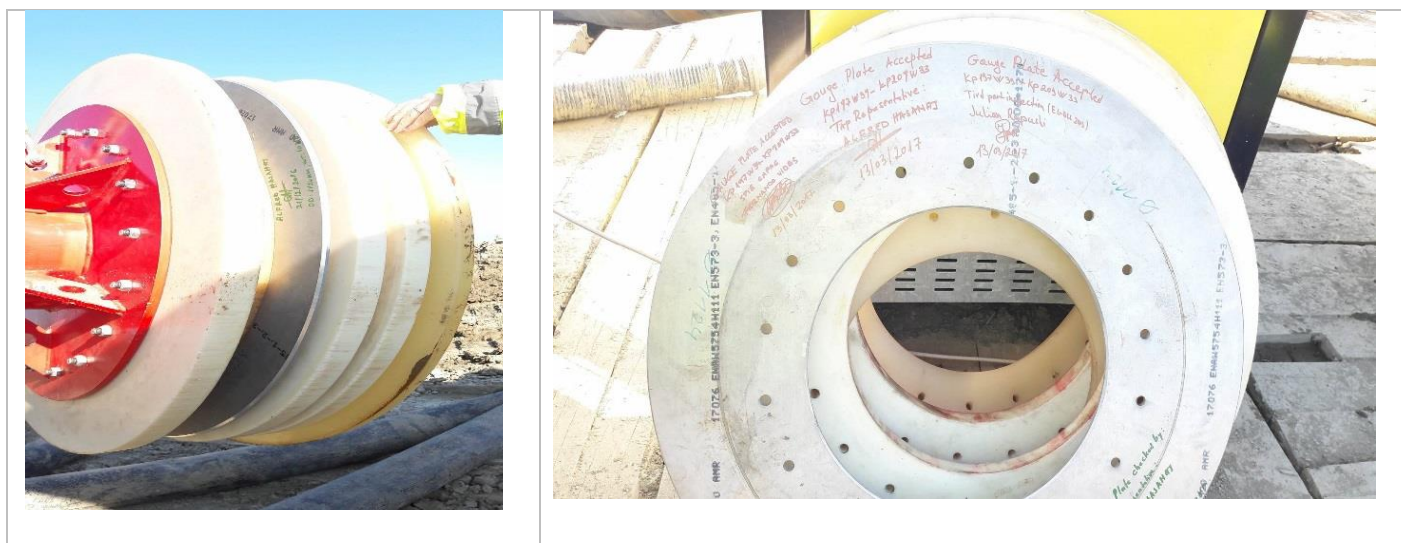
Fig. 4.18, Nuk vërehen deformime në pllakën e aluminit; Pllaka firmoset dhe pranohet
