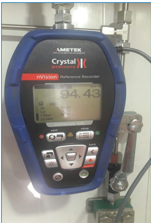
Fig.5.21, Presioni arriti 80% të testit të rrjedhjes me 2 bar/min.
