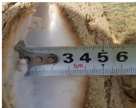
Fig 4.24, Pigu i 6 i sapo dal nga tubacioni , pothuajse i thatë dhe thellësia e futjes së ujit më pak se 4 mm
