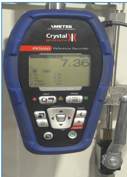
Fig.5.11, Filloj presimi deri në 50% të testit të presionit me 2 bar/min
