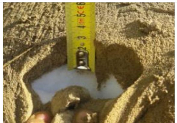
Fig 4.20, Pigu i dytë i sapo dal nga tubacioni ,më shumë se 1/4 e diametrit është e njome
