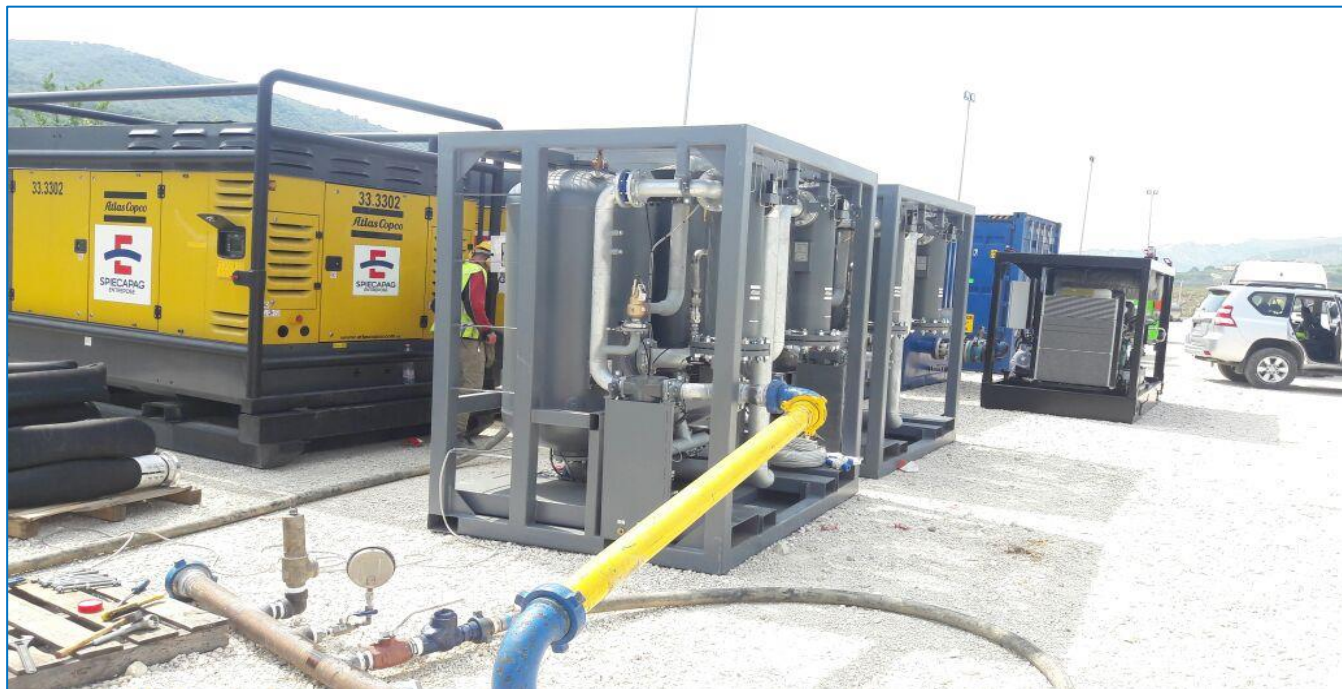
Fig 4.29, Testimi i dy pajisjeve të tharjes së tubit
