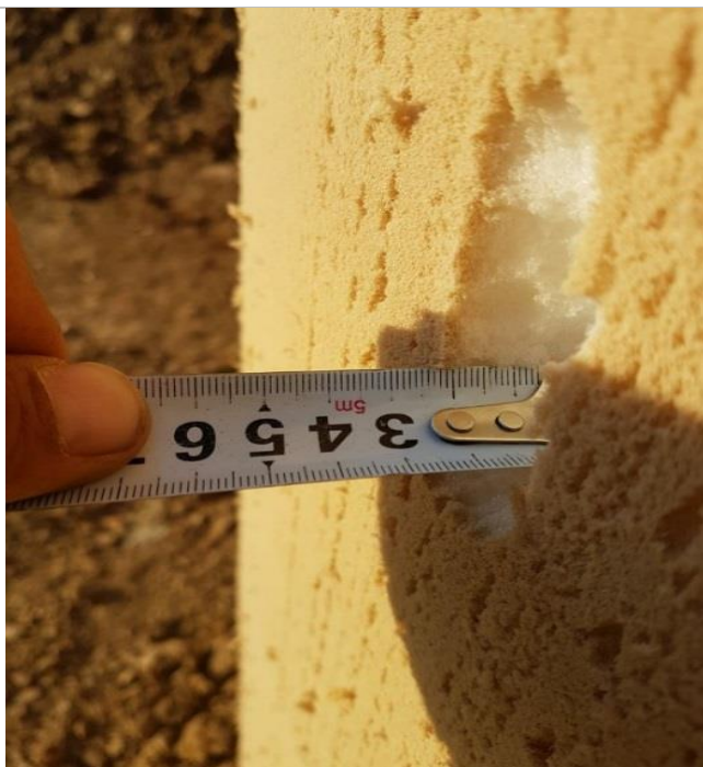
Fig 4.25, Pigu i 7 i sapo dal nga tubacioni , totalisht i thatë dhe thellësia e futjes së ujit më pak se 2 mm
