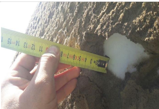
Fig 4.19, Pigu i parë i sapo dal nga tubacioni ,më shume se 3/4 e diametrit është e njome
