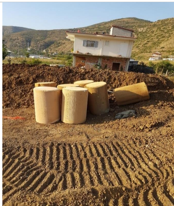
Fig 4.26, Shtate foam pig u futën në seksion për të arritur kushtet e pranueshmërisë
