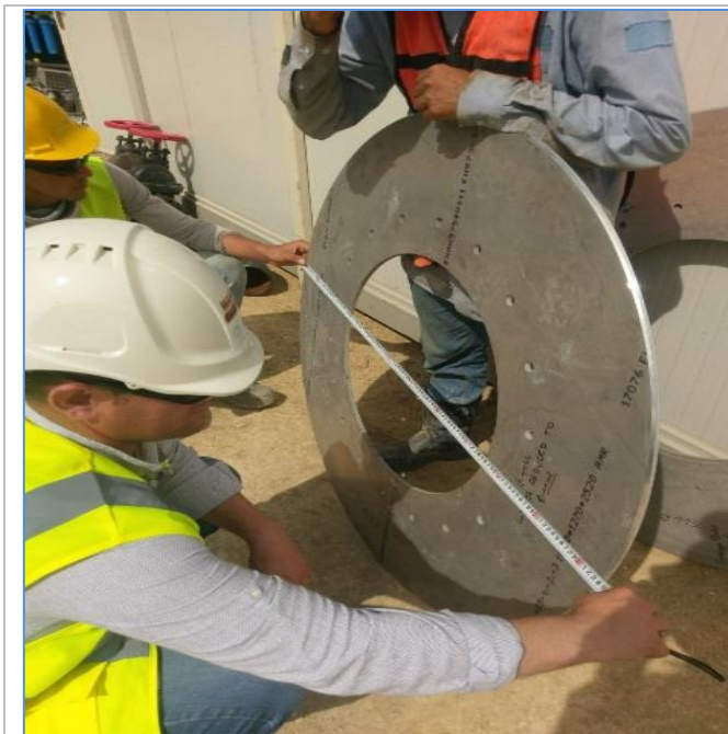
Fig 4.15, Matja e diametrit dhe e spensorit të pllakës së aluminit
