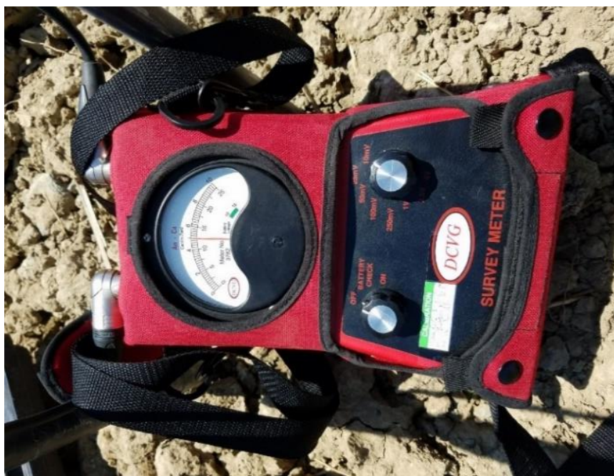
Fig.3.11.1, Instrument matës DCVG
