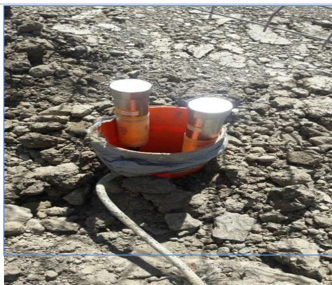
Fig.5.3,Vendosja e termometrave për matjen e temperaturës së tokës dhe tubit
