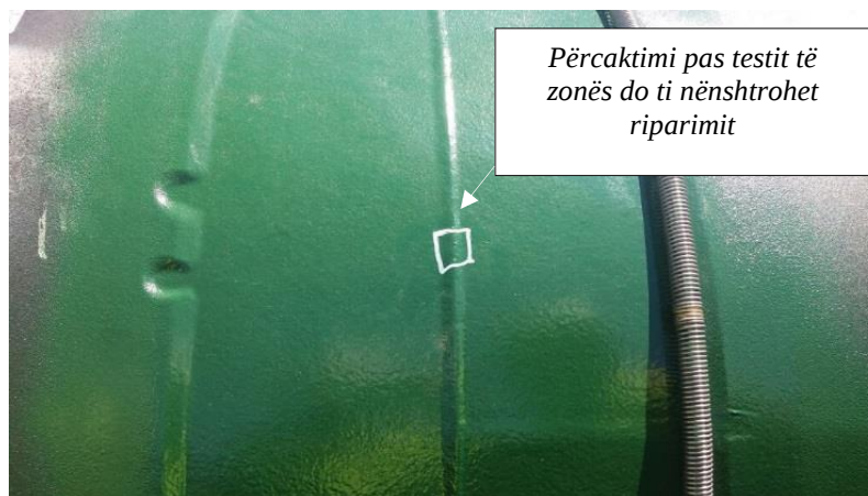
Fig.3.10, Kontrolli i nyjes së veshur me HD test.
