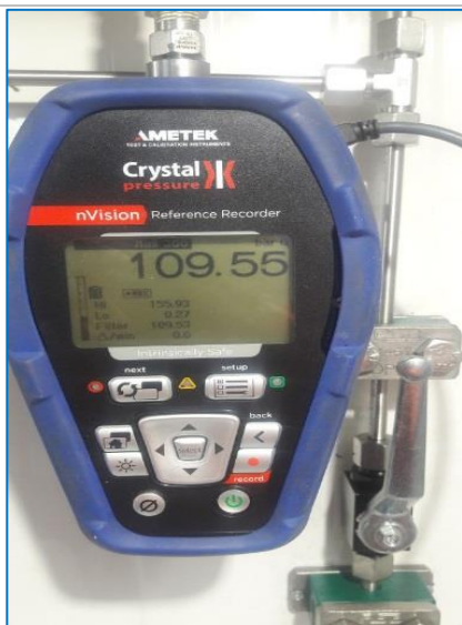
Fig.6.17, Presioni në seksion arriti 80% e presionit të testimit
