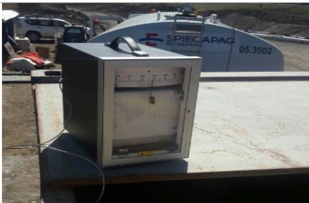
Fig.5.4, Matësi temperaturës së ujit përpara se të filloj Procesi i mbushjes
