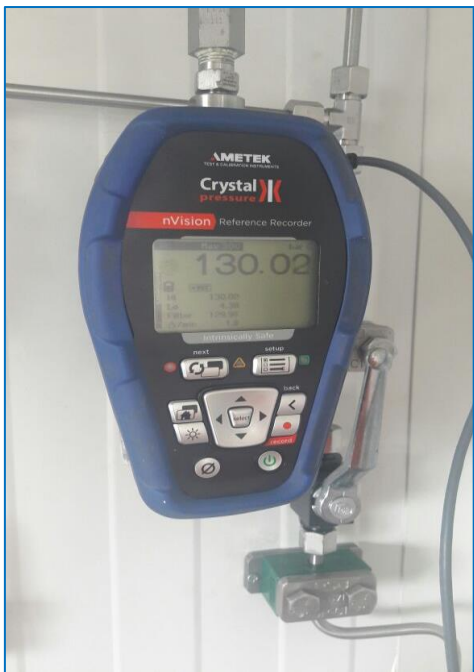
Fig 5.17, Presioni në stacion është 130 bar Filloj koha e mbajtjes nën presion për 90 min
