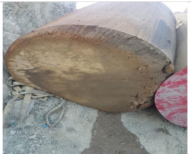
Fig 4.20, Pigu i dytë i sapo dal nga tubacioni ,më shumë se 1/4 e diametrit është e njome
