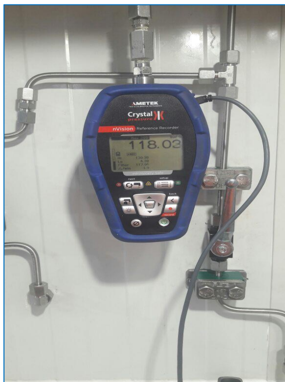
Fig.5.22 ,Presioni arriti 100% të testit të rrjedhjes (118 bar). Filloj koha e mbajtjes nën presion (Min 24 ore).
