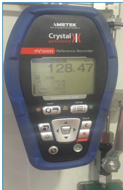
Fig 5.18, Mbaroj koha e mbajtjes presioni në fund të saj ishte 123.5 bar
