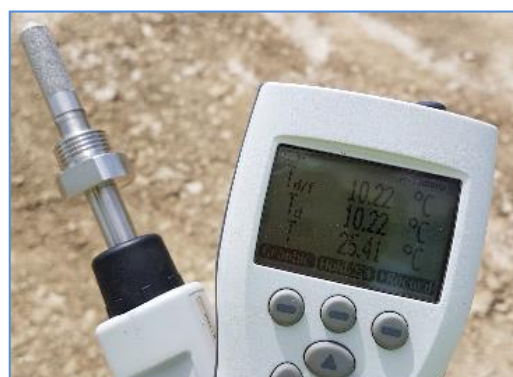
Fig 4.28, Dew Pointi i temperaturës së ambientit 10.22 °C
