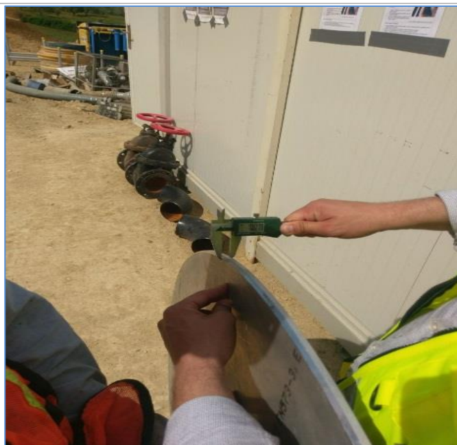
Fig 4.15, Matja e diametrit dhe e spensorit të pllakës së aluminit
