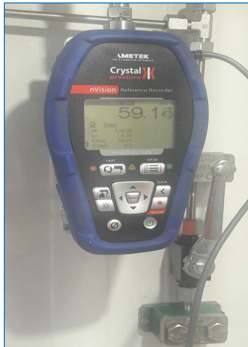
Fig 5.20, Presioni arriti 50% të testit te rrjedhjes me 2.3 bar/min
