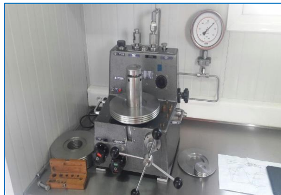
Fig. 5.14, Nga DWT presioni arriti 80% te testit te presionit
