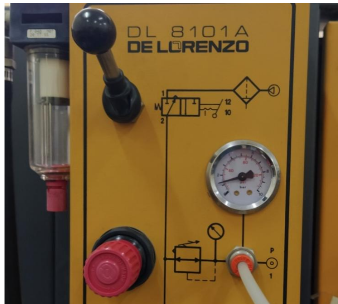
Fig. 3.2.45. Rregullatori i presionit i montuar në modelin fizik
