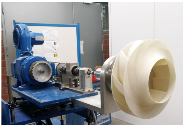
Figura 4.38 Pamja e elektromotorit që vë në lëvizje rotorin centrifugal
