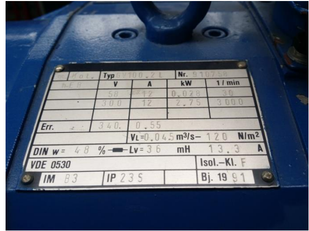
Figura 4.39 Pllaka e të dhënave teknike kryesore të elektromotorit
