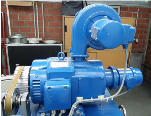
Figura 4.38 Pamja e elektromotorit që vë në lëvizje rotorin centrifugal
