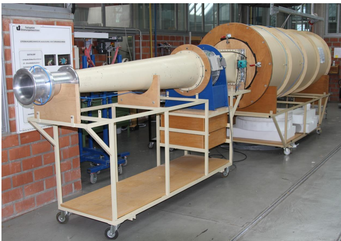
Figura 4.31 Stenda laboratorike për matjen e karakteristikave të ventilatorit, Universiteti i Siegen-it
