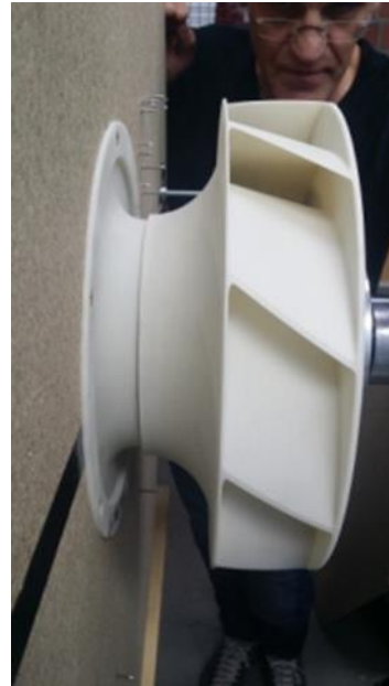
Figura 4.36 Rotori i ventilatorit centrifugal bashkë me hundzën në hyrje
