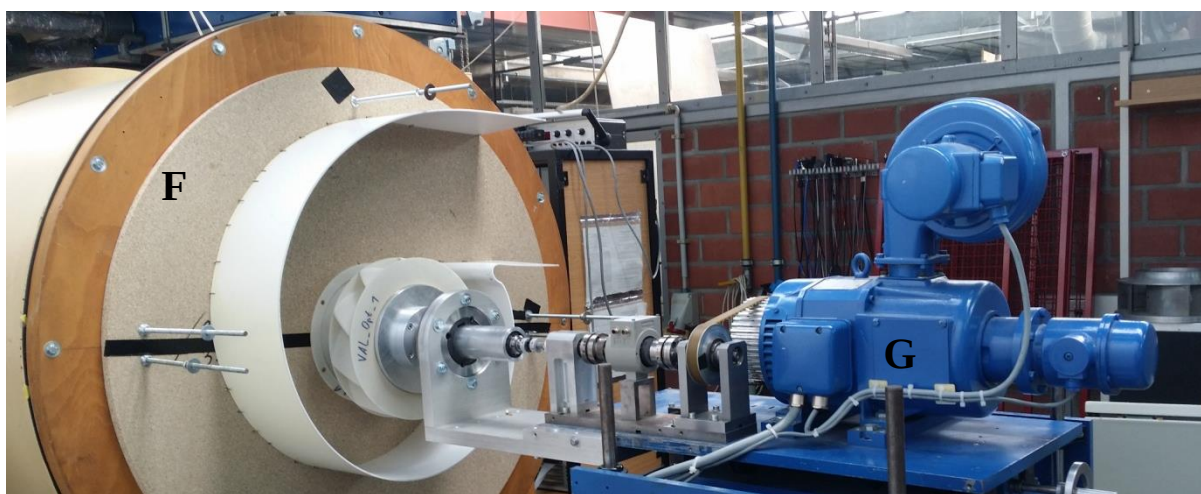
Figura 4.33 Stenda laboratorike, EN ISO 5801 [7]
