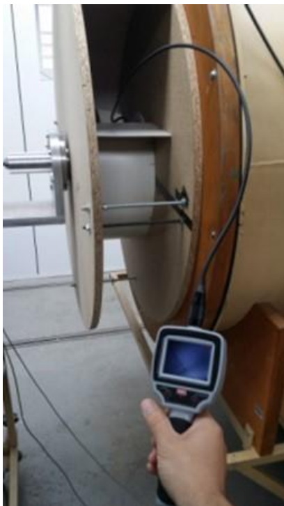
Figura 4.37 Kontrolli i vendosjes së rotorit dhe hundzës në hyrje nëpërmjet një kamere teleskopike
