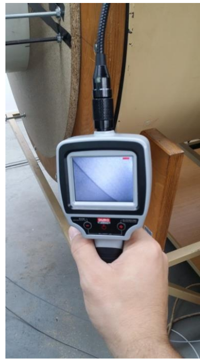
Figura 4.37 Kontrolli i vendosjes së rotorit dhe hundzës në hyrje nëpërmjet një kamere teleskopike
