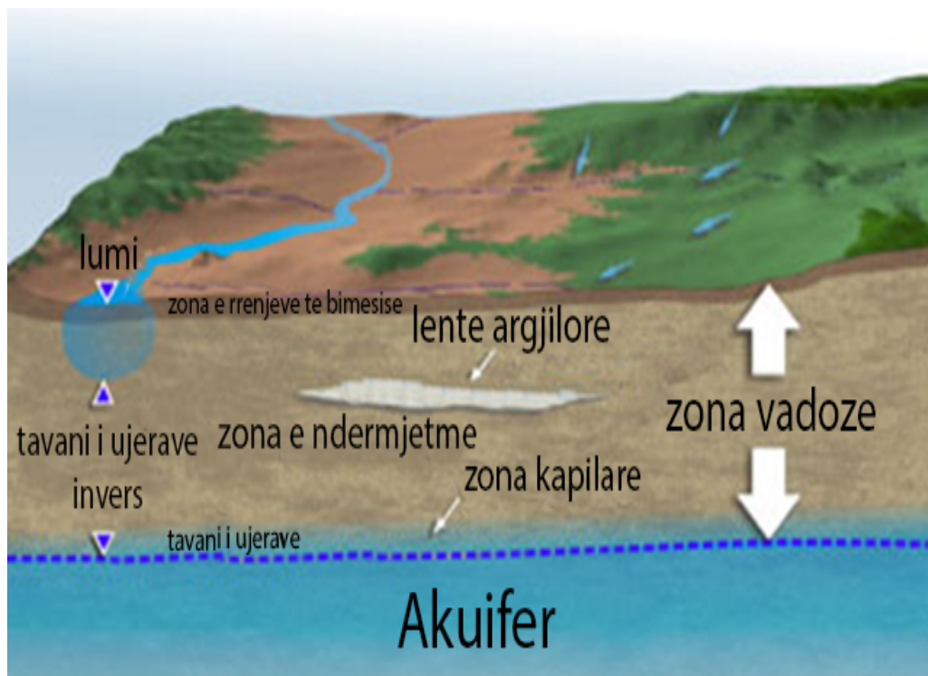
Figura 3.3 Paraqitje skematike e furnizimit me ujë të akuiferit nga lumi dhe rreshjet atmosferike.
