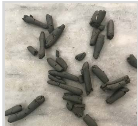
Figura 2.9 Foto e provës së dheut i punuar për plasticitetin në laborator.
