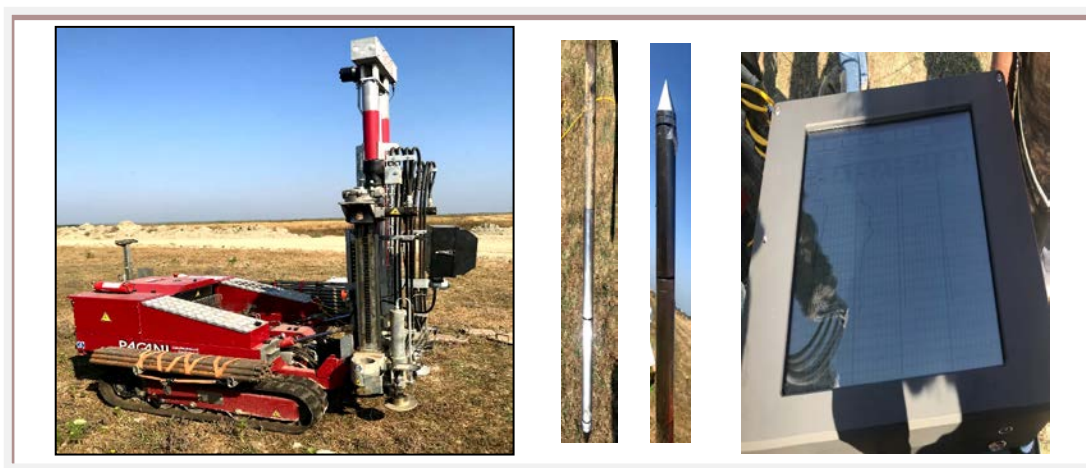
Figura 2.4 Pamje e punimeve për marrjen e provave CPTu in situ (Foto Meçaj M. 2019)
