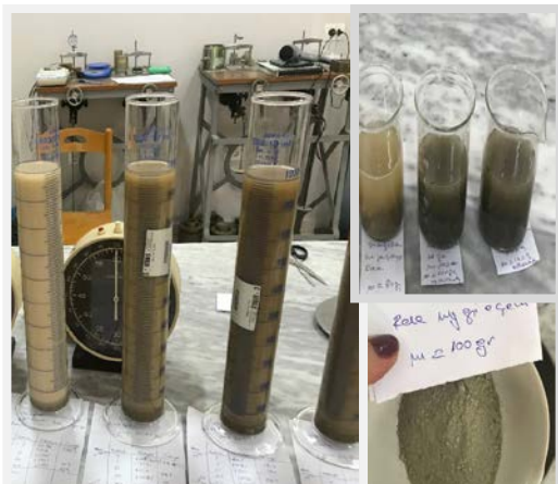
Figura 2.12 Foto nga procesi i punës për analizën me hidrometër në laborator.
