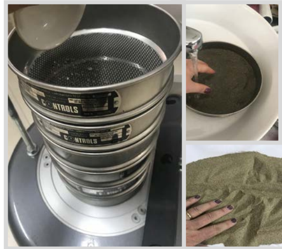
Figura 2.11 Foto e pajisjes kompleksi i sitave dhe procesi i punës.
