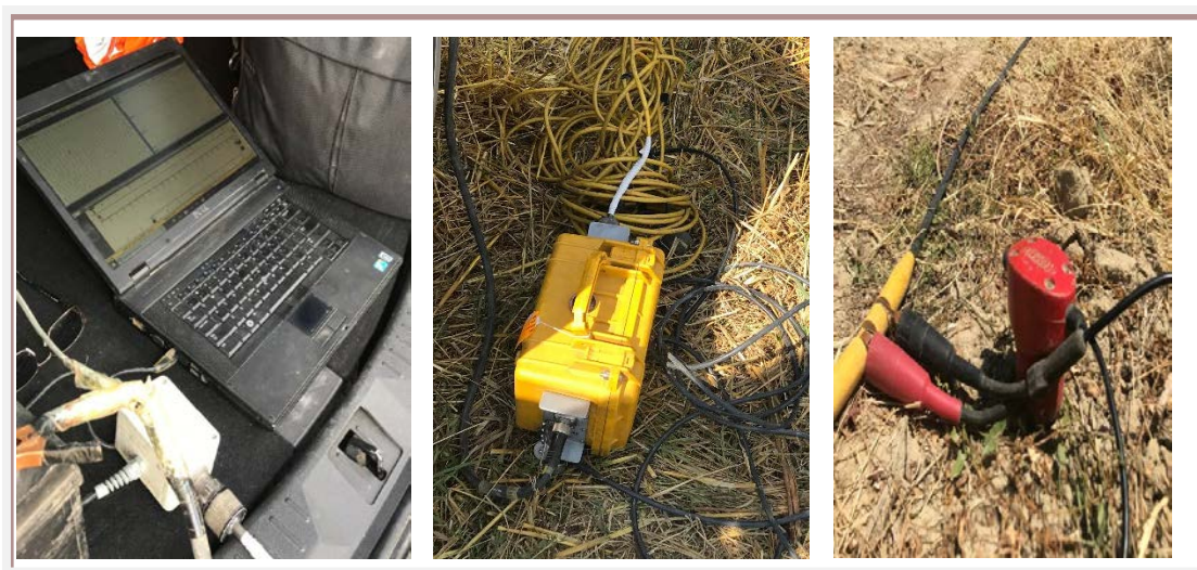
Figura 2.6 Pamje e mjeteve gjeofizike në terren për matjet MASW (Foto Meçaj M. 2020)
