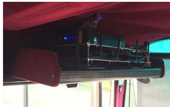
Fig. 5. Pamje e sistemit të instaluar me serverin lokal dhe infrastrukturën e komunikimit
