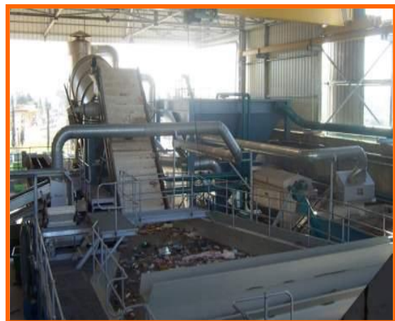
Figura 6. Impiant klasifikues i mbetjeve mekaniko-biologjike
