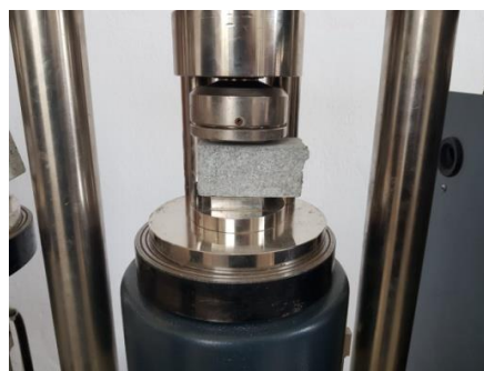
Figura 2: Testet e tullës dhe llacit në shtypje
