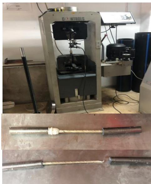
Fig.2 Testimi në laborator i shufrave GFRP
