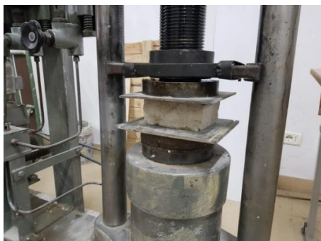
Figura 2: Testet e tullës dhe llacit në shtypje
