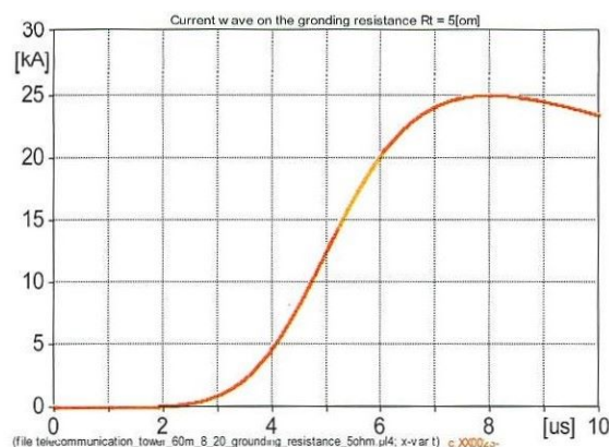
Fig. 10 Vala e rrymës me rezistencë tokëzimi R_t = 5 [\Omega] për vale standarde 8/20 [μs] të rrymës së rrufesë, me rrymë pik 100 [kA] në krye të kullës
