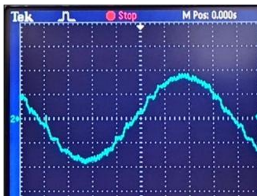
Figura 6. Forma e fem së matur në pështjellën e statorit për frekuencë 25 Hz.
