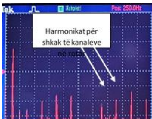
Figura 7. Analiza spektrale e fem që induktohet në pështjellën e statorit.
