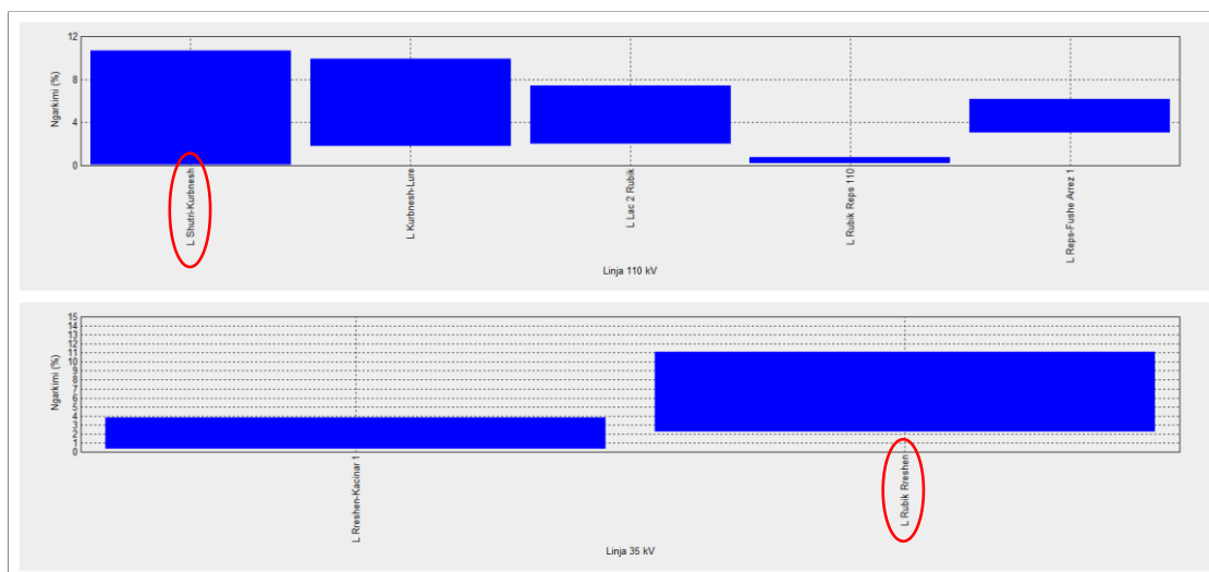
Figura 5.90 Diapazoni ngarkimit të linjave 110 kV dhe 35 kV për segmentet Shutri-Lurë dhe Laç-Reps
