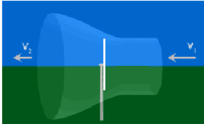
Figura 3.17 Shpejtësia para dhe pas përplasjes me rotorin e turbinës
