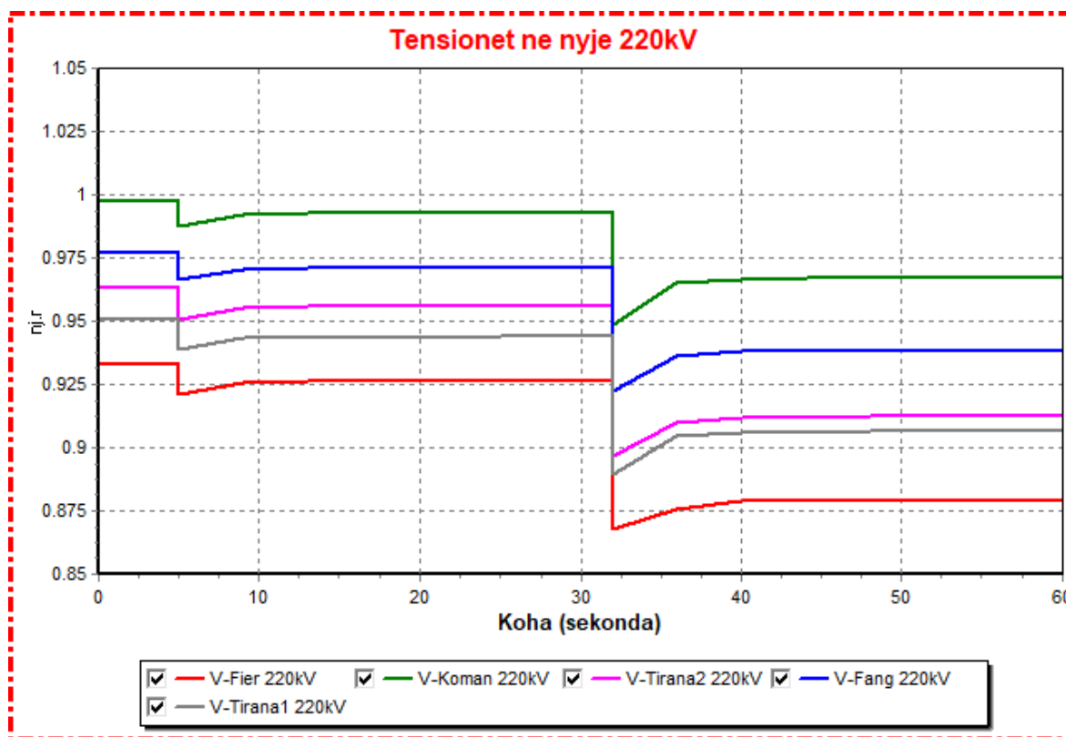
Figura 146 Tensionet ne nyjet 220kV
